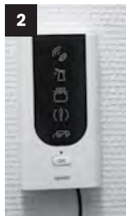
Infopanelen ansluts till uttaget via nätverksadaptorn som ingår i paketet och monteras på vägg-hållaren.
