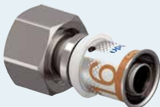
Uponor S-Press PLUS wartelmoer van adapter S-Press PLUS schroefkoppeling met vaste pershuls, aanslagring, gestante identificatie, kleurcode en testbeveiliging
