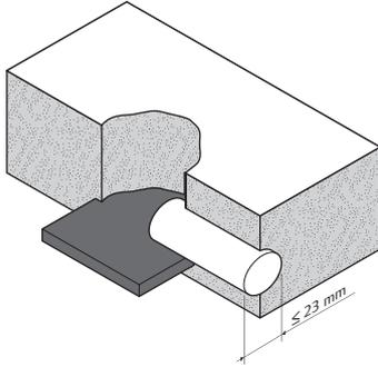
2. Inserte el tubo del sensor en el orificio donde se vaya a instalar el sensor. Asegúrese de que quede empotrado de forma segura en relación con la carga prevista de la superficie.
