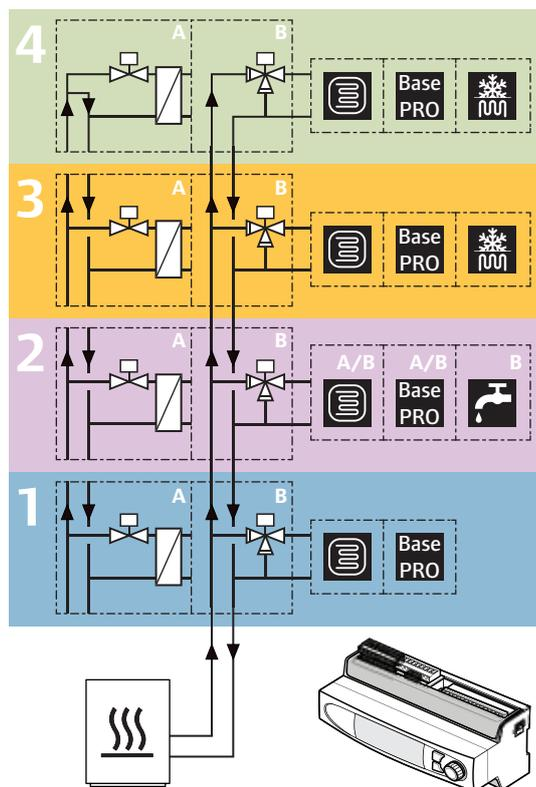
Ejemplo de conexión de la unidad base Uponor Smatrix Move PRO (con la aplicación de calefacción instalada) para regular cuatro zonas distintas (configuradas como **Control. Independiente** para calefacción por suelo radiante, **Smatrix Base PRO** también para calefacción de suelo radiante, **Agua Caliente Sanitaria** para producir agua caliente o **Deshielo** para deshelar nieve).
