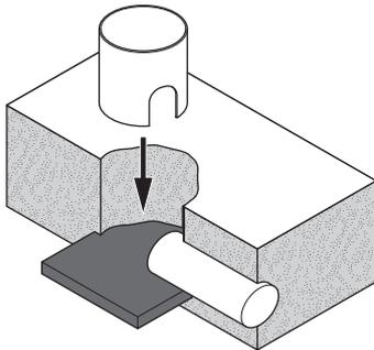
3. Inserte en el tubo del sensor el tapón de madera incluido antes de echar el hormigón o el asfalto.
