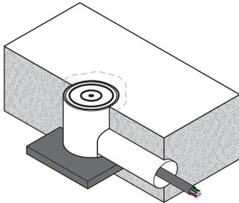
**Conecte el sensor de nieve, que se usa como sensor de temperatura del suelo, a la unidad base.**
