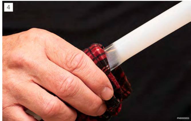
Prije upotrebe ostavite cijev da se ohladi na sobnu temperaturu ili upotrijebite mokru krpnu. Upotreba hladne vode ili puhanje hladnog zraka na popravljeni dio ubrzat će hlađenje.
