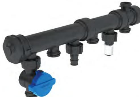
Uponor Aqua PLUS PPM je plastični sustav razdjeljika pogodan za rješenja za pitku vodu i radijatore sa širokim rasponom mogućnosti povezivanja. Instalacija je jednostavna, a s dostupnim prilagodnicima moguće je povezati cijevi različitih vrsta (Uponor PE-Xa ili kompozitne cijevi) i dimenzija. Cijevi su povezane s razdjeljikom pomoću fittinga Uponor Q&E i Uponor FPL-X za cijevi Uponor PE-Xa, fittinga Uponor S-Press za kompozitne cijevi ili pomoću kombinacije tih mogućnosti.
