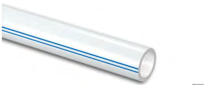
Cijev Uponor Comfort PLUS je cijev s barijerom za difuziju kisika. Ta se barijera sastoji od sloja etilen/vinil alkohola (EVOH) ekstrudiranog s vanjske strane cjevi PEX. Krajnji vanjski sloj je polietilen (PE). Taj je sloj vrlo fleksibilan i ne utječe na fleksibilnost i savitljivost osnovne cjevi.
