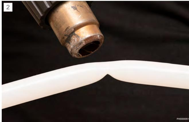
Pažljivo zagrijte oštećeno područje pištoljem za vrući zrak, okrećući pištolj oko cijevi tijekom cijelog postupka radi ravnomjerne primjene.
