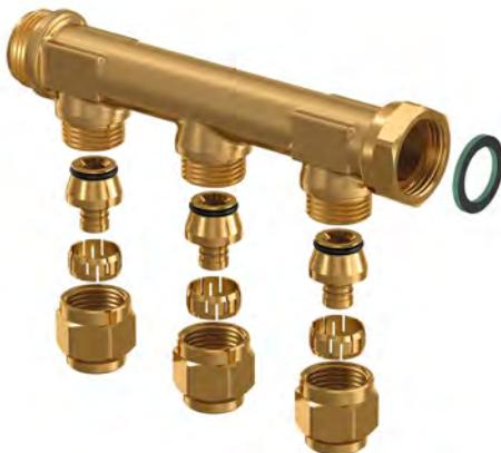
Uponor Aqua PLUS razdjelnik WTR PEX DR visokokvalitetni je razdjelnik izrađen od mesinga otpornog na odcinčavanje za primjene pitke vode. Sastoje se od fleksibilnih modula s 2 ili 3 petlje koji se isporučuju s kompresijskim fitinzima. Izlazi s vanjskim navojima G<sup>3/4</sup>".
