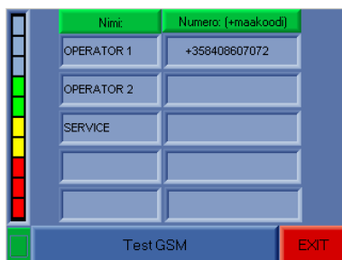
Kuva 4.11 GSM numeroiden asetus jakopumppaamon käyttöpääteellä
