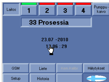
Kuva 4.18 Kellonajan säätö laitoksen päänäyttöllä
