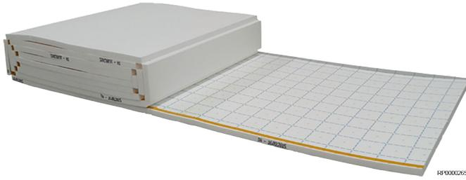
El panel rolo Uponor Klett es un panel EPS DES con grafito añadido que es ideal para aumentar el aislamiento térmico y reducir el espesor necesario. Está disponible en versiones 25-2, 30-2, 30-3, 35-3 y lleva integrado el aislamiento térmico y frente al ruido de impacto según la norma DIN EN 13163.
