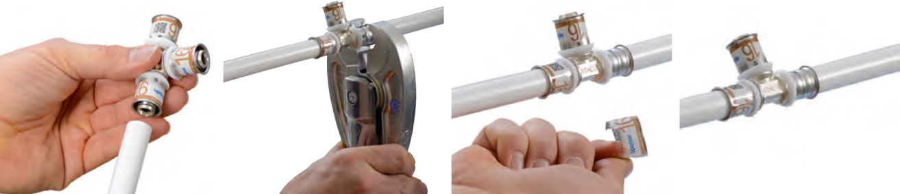
1 - Insérer le tube dans le raccord en butée 2 - Utiliser la mâchoire autour de la bague inox 3 - Après sertissage, retirer le film plastique 4 - Raccord étanche et robuste
