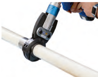
2 - Accrocher la mâchoire de base sur l'extension de mâchoire et sertir
