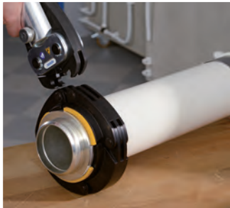
2 - Accrocher la mâchoire de base sur l'extension de mâchoire et sertir. Après sertissage, la bague inox présente une claire déformation (repère visuel)
