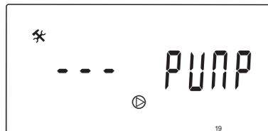
Установка времени продолжительности выключенного состояния циркуляционного насоса после закрытия клапана смесителя.
