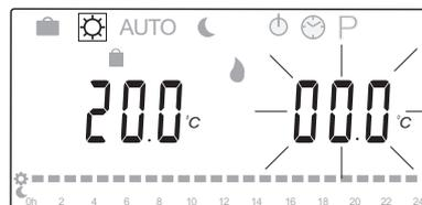
При выходе из первоначального режима изменения, подождя около 7 секунд или нажав кнопку **OK**, контроллер показывает текущую температуру подачи и наружную температуру. С помощью кнопки **OK** переключаются режимы изменения и дисплея.
