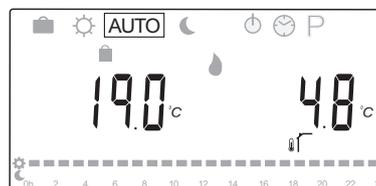
Через эти 7 секунд отображается текущая температура подачи вместо расчетной. С помощью кнопки **OK** можно в любое время переключать эти значения в **Автоматическом режиме**.
