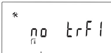
Этот параметр доступен, только если параметр 5 — «Выбор термостата» — установлен на «rF».
