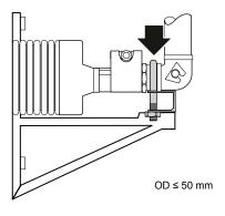
Fijación de la abrazadera de tubería al codo de tubería (OD ≤ 50 mm)
