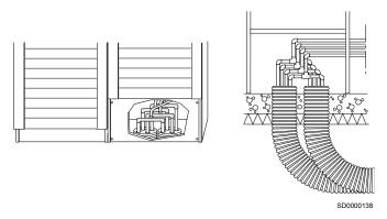
La flexibilidad del sistema de tuberías permite planificar las zanjas de forma flexible y teniendo en cuenta el entorno. Cuando la tubería se introduce en el edificio, la selección de la ubicación de entrada debe tener en cuenta los requisitos de espacio del radio de flexión de la tubería.
