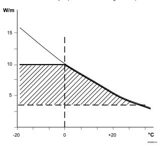
El cable antiheladas proporciona la potencia necesaria en caso de hielo, agua fría o tuberías congeladas. El área rayada de la imagen muestra la potencia de entrada en W/m en función de la temperatura exterior cuando el cable antiheladas está conectado.
