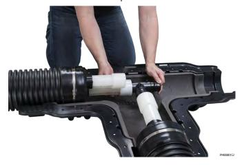
El accesorio Uponor Q&E se basa en un método según el cual una tubería Uponor PE-Xa se expande gradualmente con un anillo Q&E (PEX) colocado en el exterior y, a continuación, vuelve a contraerse sobre una boquilla de ajuste. Esta técnica es posible porque el material Uponor PEX es capaz de contraerse hasta casi su tamaño original incluso después de haberse expandido en gran medida.
