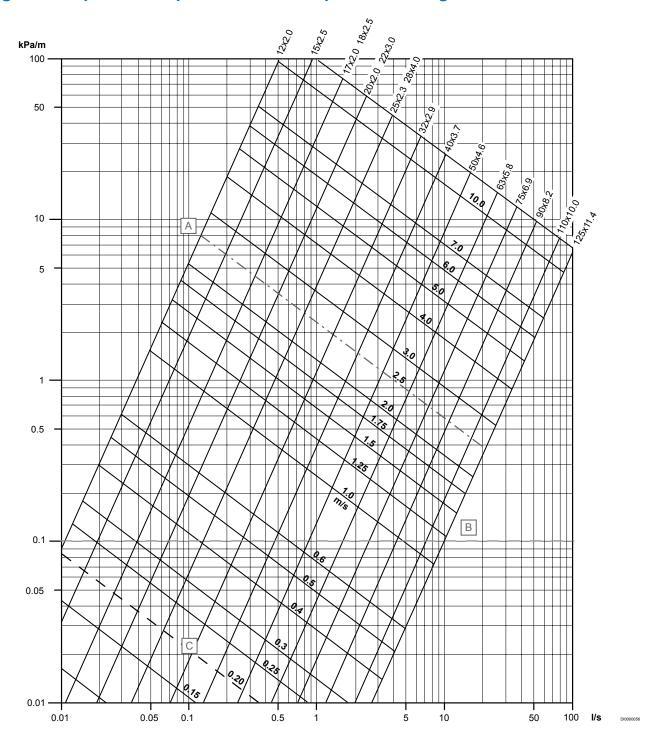
El nomograma se calcula a una temperatura del agua de +70 °C.
