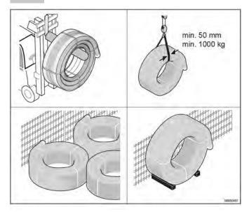
No arrastre la bobina por superficies rugosas. Asegúrese de que la bobina no se aplaste y de que la tubería no se abolle al enrollarla
