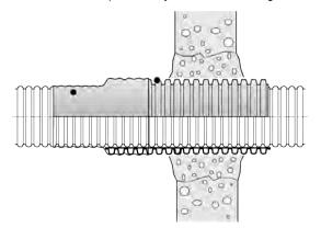
La funda de manguito termorretráctil evita que el agua se filtre a los cimientos entre la tubería y el pasamuro.
