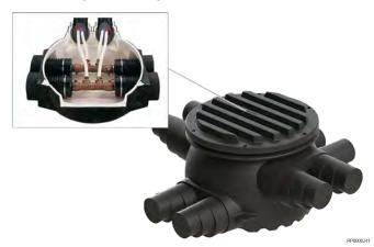
Sin distribución de carga y bajo una capa de arena de 50 cm, la arqueta puede soportar una carga a corto plazo de 3000 kg (6000 kg/  $\rm m^2$ ); por ejemplo, el paso de un tractor. La tapa de la arqueta puede soportar una carga continua de hasta 500 kg (1000 kg/m²); por ejemplo, un automóvil estacionado.
