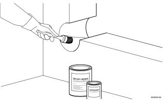
Las paredes del orificio perforado deben recubrirse con resina epoxi antes de instalar el pasamuro estanco Uponor Ecoflex.
