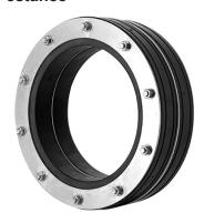
Debe usarse una junta mural estanca bajo presión Uponor siempre que esté previsto que haya agua a presión; por ejemplo, debido a un nivel freático elevado. Se puede utilizar directamente en orificio revestido practicado en el hormigón estanco, o bien en un pasamuro de fibrocemento que se hormigona o tapia en su lugar.
