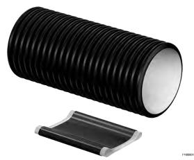
El pasamuro NO resistente a agua a presión es estanco en ausencia de presión (NPW) y se puede usar para pasar a través de los cimientos del edificio por encima del nivel freático del suelo. El pasamuro se monta en su lugar antes de echar los cimientos o se instala a través de un orificio perforado posteriormente.
