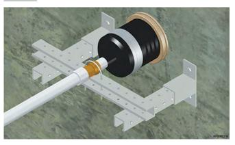
Los tamaños de tubería pequeños (diámetro exterior medio ≤ 50 mm) se suelen poder anclar con los soportes de la pieza de unión del equipo. Las tuberías de gran tamaño (diámetro exterior medio >50 mm) deben anclarse mediante una unión de punto fijo independiente.
