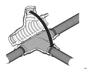
Los sets cubren las diferentes dimensiones de carcasas exteriores y se ajustan a las tuberías Single y Twin por igual. Se incluyen todos los componentes necesarios, como coquillas de espuma, pernos y kit de sellado.
