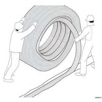
Desenrollado de tuberías desde el interior (recomendado para carcasas exteriores con diámetros de 68 a 175 mm o longitudes enrolladas de hasta 50 m).
