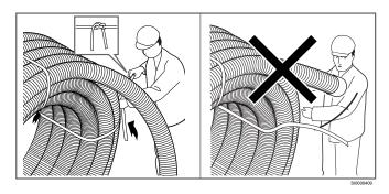
Al empotrar tramos de tubería, se debe dejar una longitud de tubería libre suficiente, de 3 a 5 metros, para instalar los sistemas de conexión. Cuando cambia el material del tubo interior, de acero a plástico, se puede transferir tensión del tubo de acero al de plástico durante los cambios de temperatura. En este caso, se deben evitar especialmente las fuerzas de cizallamiento; si es necesario, proporcione puntos fijos alrededor de los extremos del tubo interior de acero.
