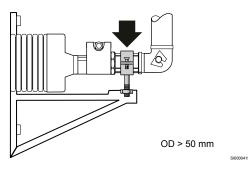
Fijación de la abrazadera de tubería a la unión de punto fijo Wipex (OD >50 mm)
