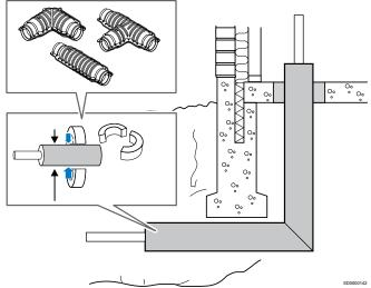
Los codos de conexión para vivienda Uponor Ecoflex se conectan con los sets de aislamiento Ecoflex (excepto el codo de conexión para vivienda Twin 75, que se conecta con el set de carcasa 250).
