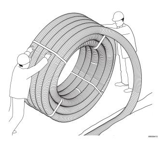
Desenrollado de tuberías desde el exterior (recomendado para carcasas exteriores con diámetros de 68 a 250 mm o longitudes enrolladas superiores a 50 m).
