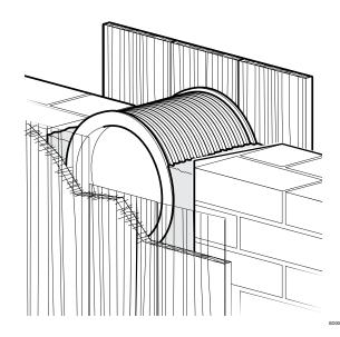
El pasamuro de fibrocemento se puede fijar en una pared de ladrillos o introducir en una pared de hormigón.
