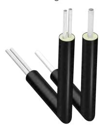
Uponor ofrece el codo de conexión pre-aislado para vivienda Ecoflex que simplifica el acceso a la vivienda a través de la losa del suelo con un radio de flexión mínimo. Consta de tubos interiores de PE-Xa con espuma de poliuretano con una carcasa exterior de PE-HD.
