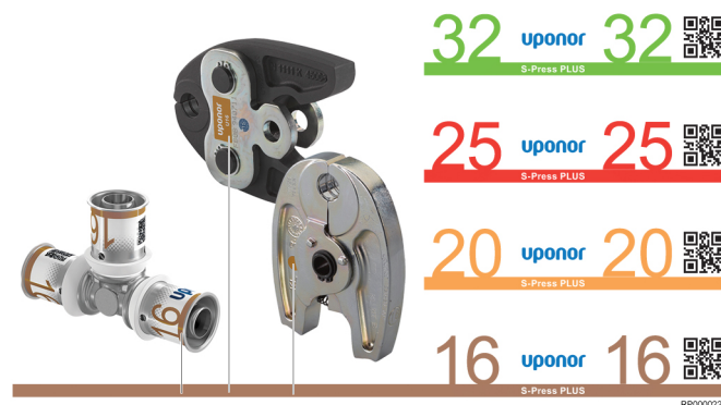
Färgkodning av Uponor S-Press PLUS-kopplingar 16–32 mm
