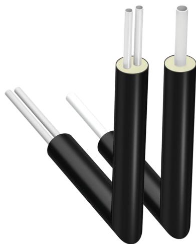
Uponor siūlo izoliuotą Ecoflex prijungimo alkūnę, kad būtų paprasčiau įvesti į namus per grindų plokštę taikant minimalų lenkimo spindulį. Ją sudaro poliuretano putplastčiu padengti PE-Xa vidiniai vamzdžiai su išoriniu PE-HD gaubtu.
