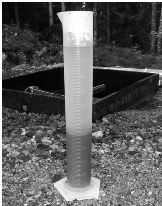
Bild 5.4 Sedimenteringsprov efter 90 minuter
