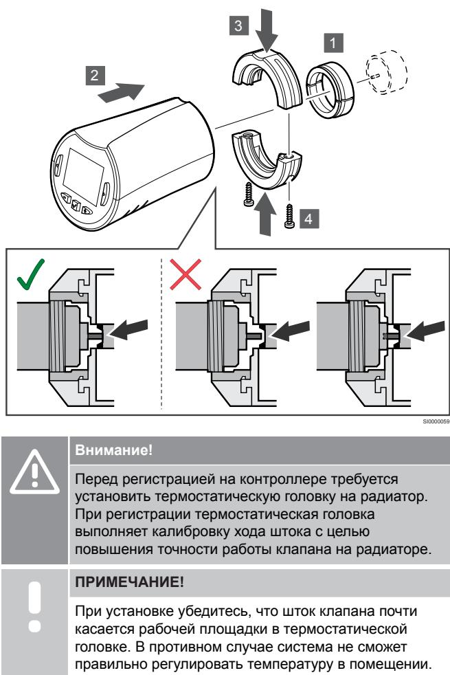
Терmostатические головки поставляются в комплектах, которые включают переходники, пластиковые крепежи и винты.
