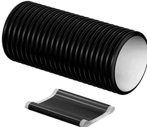
Set zidne puše je ne-tlačen in vodoodporn (NPW) ter se lahko uporablja za dovod skozi temelje zgradbe nad gladino podtalnice. Zidna puša se namesti v času vlivanja temeljev ali pa se vgradi v odprtino, ki je naknadno izvrtna.
