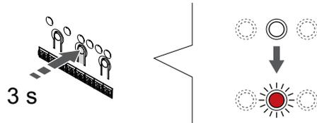
Pulse y mantenga pulsado el botón **OK** del controlador de habitación hasta que el LED del canal 1 (o el primer canal no registrado) parpadee en rojo.
