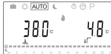
Die aktuelle Uhrzeit blinkt ständig unten im Bildschirm und zeigt an, welche Betriebsart gegenwärtig aktiv ist (Normal oder ECO). Daher müssen Uhrzeit und Datum eingestellt sowie ein geplantes Programm ausgewählt werden.
