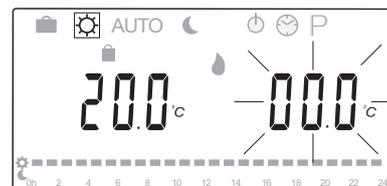
Beim Verlassen der ursprünglichen Bearbeitungsebene, indem entweder etwa 7 Sekunden gewartet oder die Schaltfläche **OK** betätigt wird, zeigt das Regelmodul die aktuellen Vorlauf- und Außentemperaturen an. Mit **OK** kann zwischen Bearbeitung und Anzeige umgeschaltet werden.
