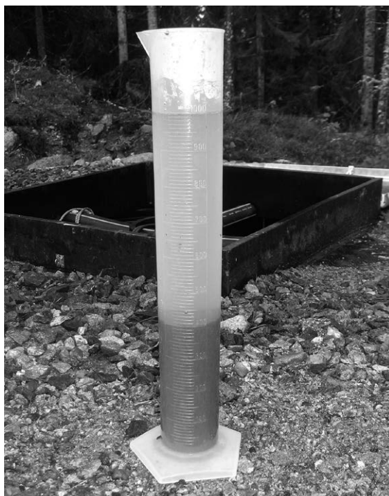
Bild 5.4 Sedimenteringsprov efter 90 minuter
