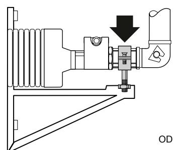
Kačenje stezaljke za cevi na Wipex spoj sa fiksnom tačkom (OD > 50 mm)
