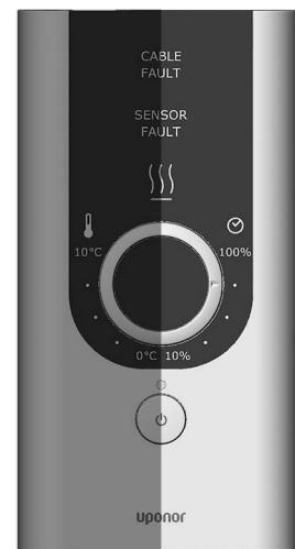
Tajmer se koristi za regulisanje napajanja kabla. To je lak način za smanjenje potrošnje energije i za sprečavanje štetnog zagrevanja vode u cevovodu. Oblast regulisanja tajmera odgovara ciklusu prebacivanja od 30 minuta.
