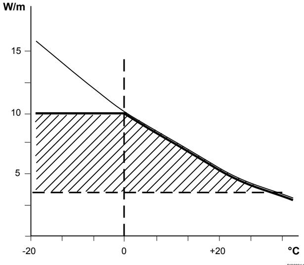
Kabl za zaštitu od smrzavanja isporučuje punu snagu do cevovoda sa ledenom, hladnom vodom ili smrznutog cevovoda. Šrafigana oblast na slici prikazuje ulaznu snagu W/m u zavisnosti od spoljašnje temperature kada je kabl za zaštitu od smrzavanja neprekidno uključen.
