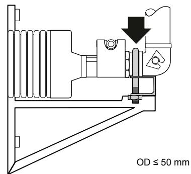
Kačenje stezaljke za cevi na koleno cevi (OD ≤ 50 mm)
