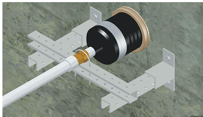
Cevi malih veličina (srednja cev OD ≤ 50 mm) mogu se ubičajeno pričvrstiti držaćima spojenog dela opreme. Cevi velikih veličina (srednja cev OD > 50 mm) moraju se pričvrstiti pomoću zasebnog spoja sa fiksnom tačkom.
