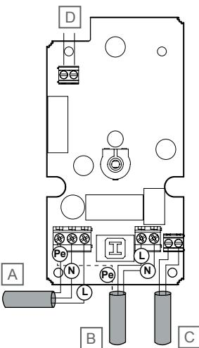
Funkcija termostata se koristi za kontrolisanje kabla kada ne bi trebalo prekoračiti određenu unapred zadatu temperaturu. Temperaturni opseg koji se kontroliše pomoću termostata je 0–10 °C, a kontrola se odvija pomoću točkića za podešavanje na jedinici termostata.
