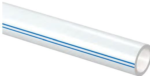
Uponor Magna Pipe PLUS ist ein hochflexibles PE-Xa-Rohr mit 5 Schichten in den Abmessungen 20 x 2,0 mm und 25 x 2,3 mm.
