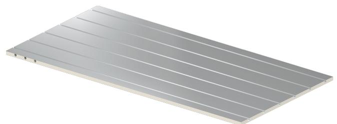
El Uponor Siccus Mini es un panel XPS de 400 kpa con dimensiones de 1200 x 600 x 15 mm que se puede instalar sobre el piso existente. El panel prefabricado tiene integradas las ranuras para la instalación de tuberías con una distancia única entre tuberías de 100 mm.
