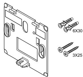
Termostat je dobavljen v paketu, ki vsebuje vijke, zidne vložke in stenski nosilec, s katerimi lahko namestite termostat na steno na več načinov.
