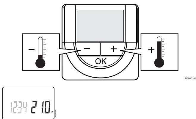
Za spremembo nastavljene temperature na termostatu trenutnega načina delovanja:
