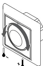
Za spremembo nastavljenih temperature na termostatu:
