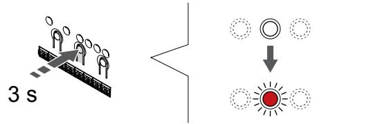
Pritisnite in držite gumb **V redu** na priključnem modulu, dokler LED-dioda na kanalu 1 (ali na prvem neregistriranem kanalu) ne začne utripati v rdeči barvi.
