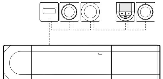
Na spodnjem primeru so termostati povezani zaporedno. Na ta način povezava s priključnim modulom in pomožnim modulom (če je na voljo) poteka le prek enega kabla.
