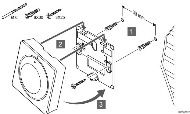
Termostat pritrdite na steno z uporabo stenskega nosilca, vijakov in zidnih vložkov.
