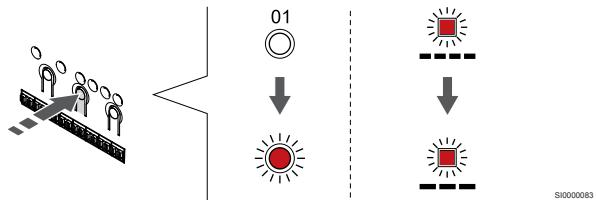
Pritisnite gumb **V redu** za vstop v način za registracijo sistemskih naprav (LED-dioda napajanja). LED dioda napajanja začne utripati v skladu z vzorcem: dolg utrip, kratka pavza, dolg utrip. LED dioda na kanalu 1 začne utripati v rdeči barvi.
