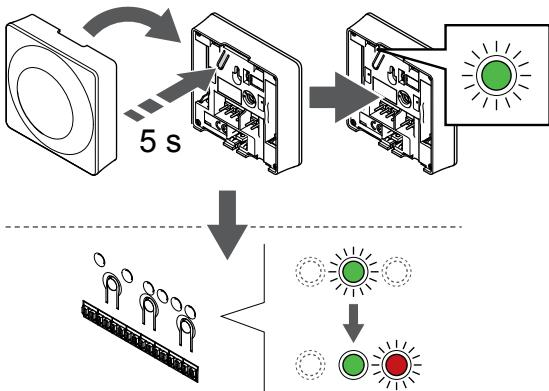
Nežno pritisnite in pridržite gumb za registracijo na termostatu ter ga izpustite, ko začne utripati LED dioda (v odprtini nad gumbom za registracijo).
