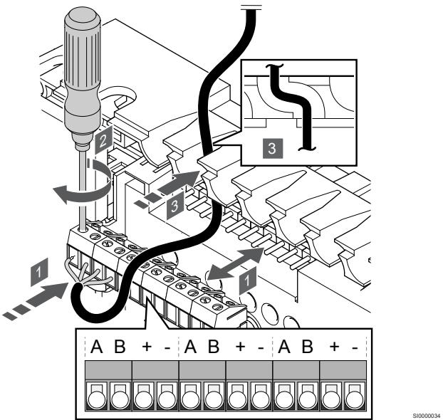
1. Kable napeljite skozi kabelske vhode na zgornji strani ohišja priključnega modula.
