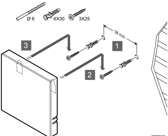
Pritrdite termostat na steno z uporabo vijaka in zidnega vložka.
