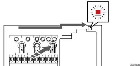
Uporabite gumb **< ali >** za premik kazalca na LED-diodo napajanja (rdeča LED-dioda utripa).
