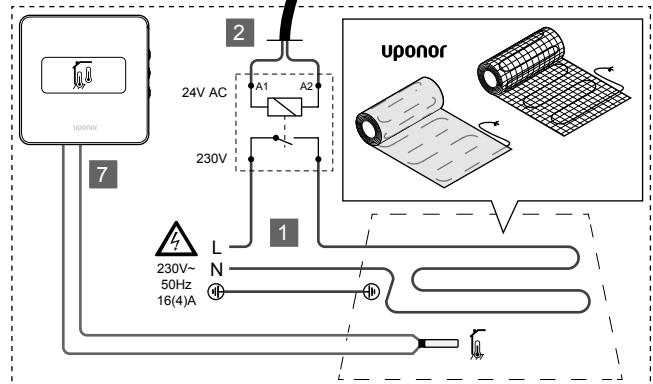
1. Preprogo/žico električnega talnega ogrevanja priključite na rele 24 V AC, ki je dimenzioniran za pravilno obremenitev.
