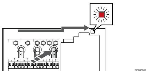
Uporabite gumb < ali > za premik kazalca na LED-diodo napajanja (rdeča LED-dioda utripa).
