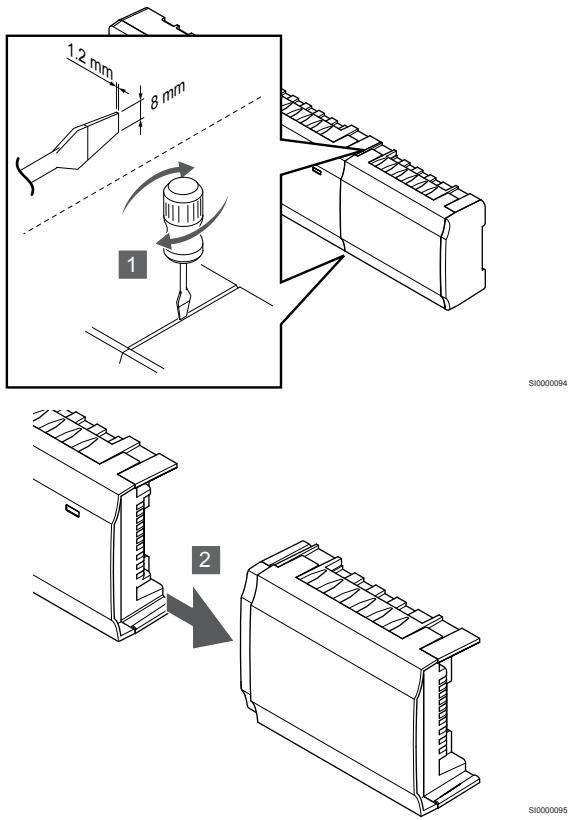
1. Vstavite široki izvijač v režo med pomožnim modulom in drugo enoto in obrnite izvijač, da se naredi razmak med obema enotama. Ponovite postopek še za drugo stran.
