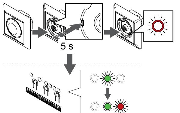
S koničastim orodjem nežno pritisnite in pridržite gumb za registracijo na termostatu ter ga izpustite, ko začne utripati LED dioda nad vrtljivim gumbom.
