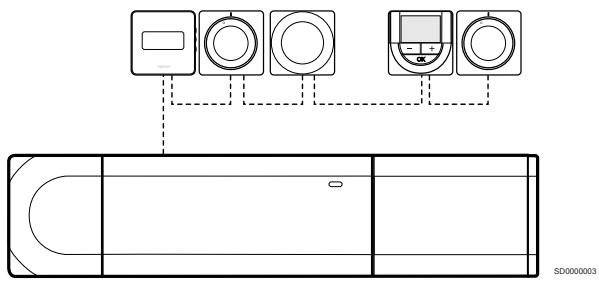
Na spodnjem primeru so termostati povezani zaporedno. Na ta način povezava s priključnim modulom in pomožnim modulom (če je na voljo) poteka le prek enega kabla.
