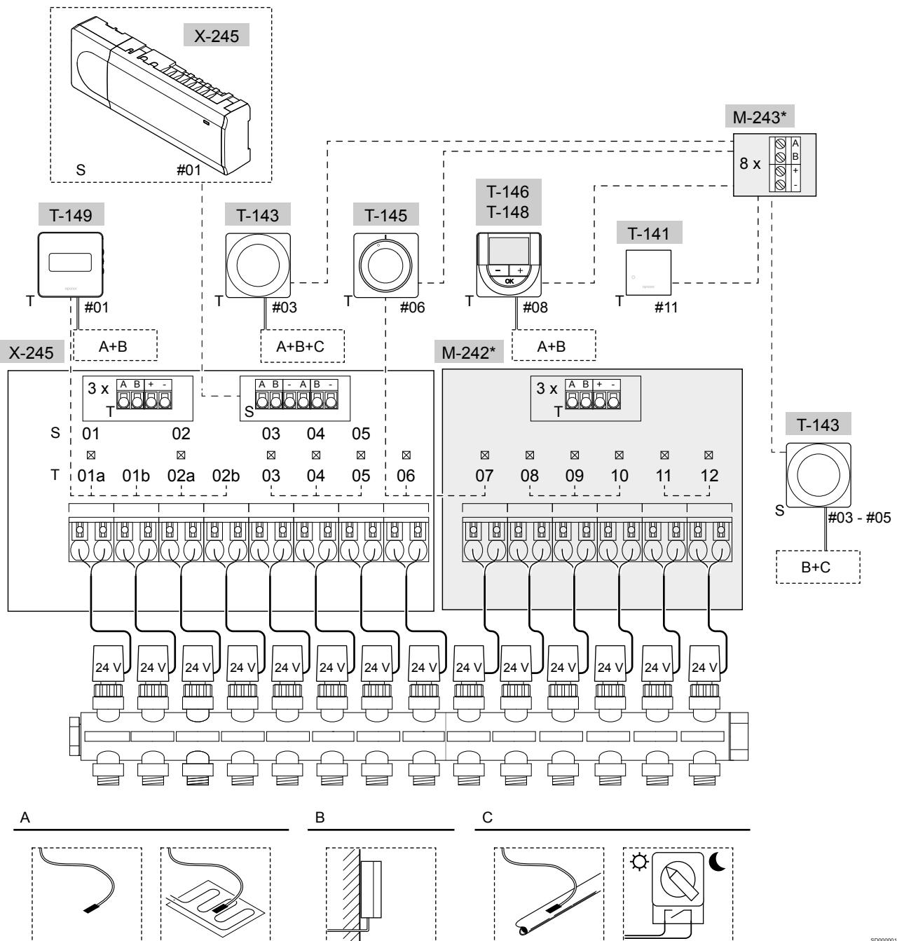
\*) Ta primer prikazuje dodatni pribor, ki Uponor Smatrix Base Pulse priključnemu modulu doda šest vhodov za termopogone (pomožni modul M-242) in dodatne bus konektorje (pomožni modul M-242 in zvezdasti modul M-243)
