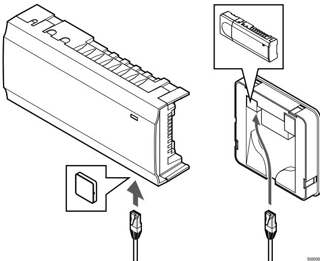
Prišteženi komunikacijski kabel priključite na komunikacijski modul in priključni modul.
