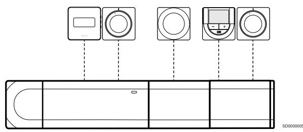
Zvezdasti modul je vgrajen na priključni modul in pomožni modul (če je na voljo) kot razširitev priključnih konektorjev v sistemu. Vsek termostat na spodnjem primeru je priključen direktno na priključni modul, pomožni modul (če je na voljo) in zvezdasti modul.
