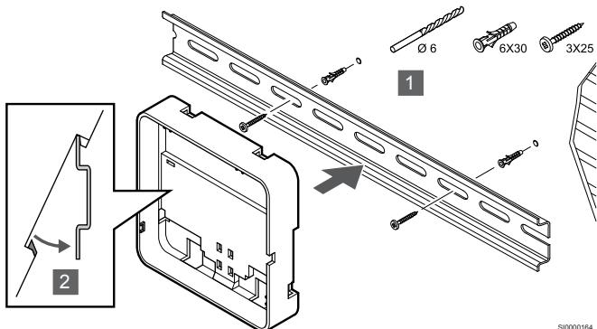
1. Z uporabo vijakov in zidnih vložkov pritrdite DIN letev/nosilec na steno.
