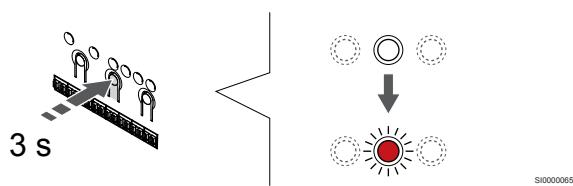
Pritisnite in držite gumb V redu na priključnem modulu, dokler LED-dioda na kanalu 1 (ali na prvem neregistriranem kanalu) ne začne utripati v rdeči barvi.
