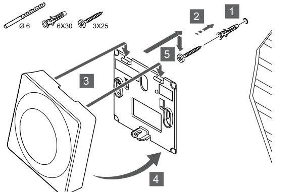
Pritrdite termostat na steno z uporabo vijaka in zidnega vložka.
