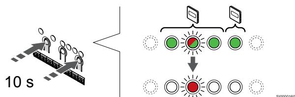
Pritisnite gumb < in ura > in ju držite, dokler se LED-diode vseh kanalov (izjema je LED-dioda napajanja) ne izklopijo (približno 10 sekund). LED dioda napajanja utripa v rdeči barvi.
