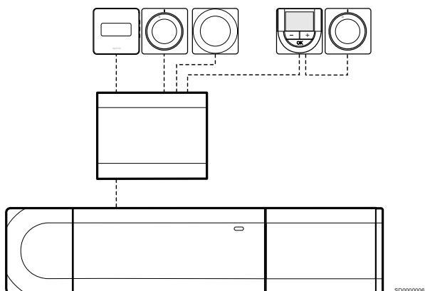
Zvezdasti modul je povezan s priključnim modulom in/ali pomožnim modulom (če je na voljo) s kablom, pri tem pa sta uporabljeni dve dodatni priključni mesti. Vsak termostat je, na spodnjem primeru, priključen direktno na zvezdasti modul, razen dveh, ki sta povezana zaporedno.
