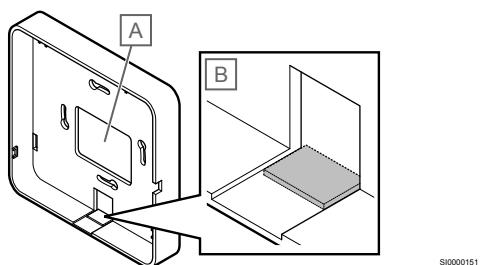
Napeljite kable do komunikacijskega modula skozi enega od dveh kabelskih vhodov.
