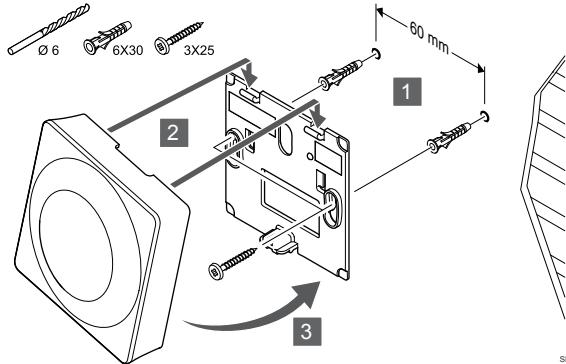
Termostat pritrdirite na steno z uporabo stenskega nosilca, vijkev in zidnih vložkov.
