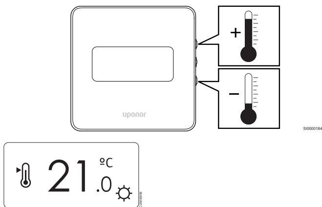
Za spremembo nastavljene temperature na termostatu trenutnega načina delovanja:
