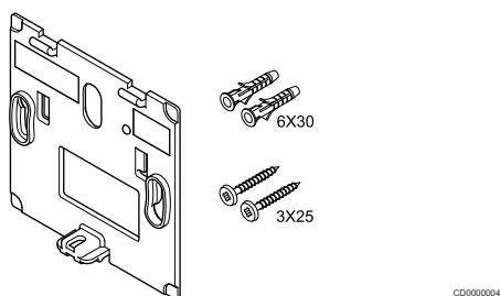
Termostat je dobavljen v paketu, ki vsebuje vijake, zidne vložke in stenski nosilec, s katerimi lahko namestite termostat na steno na več načinov.
