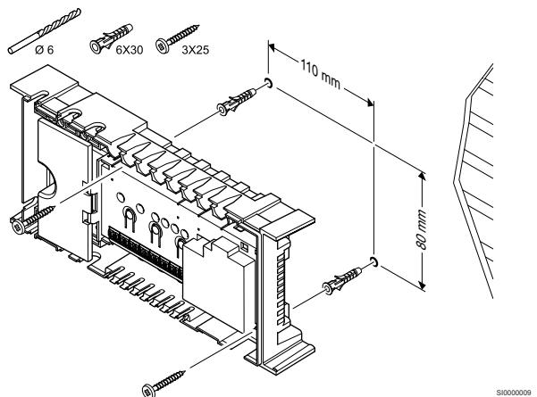
Pritrdite priključni modul na steno z uporabo vijakov in zidnih vložkov.
