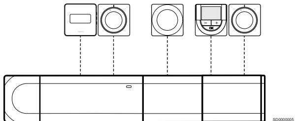
Zvezdasti modul je vgrajen na priključni modul in pomožni modul (če je na voljo) kot razširitev priključnih konektorjev v sistemu. Vsak termostat na spodnjem primeru je priključen direktno na priključni modul, pomožni modul (če je na voljo) in zvezdasti modul.
