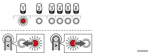
Uporabite gumb **< ali >** za premik kazalca (LED-dioda utripa rdeče) na kanal, ki ga želite deregistrirati (LED-dioda sveti neprekiniteno zeleno).
