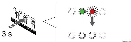
Pritisnite in držite gumb V redu na priključnem modulu, dokler se LED-diode ne izklopijo, da zaključite registracijo in se vrnete v obratovalni način.
