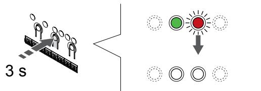
Pritisnite in držite gumb V redu na priključnem modulu, dokler se LED-diode ne izklopijo, da zaključite registracijo in se vrnete v obratovalni način.
