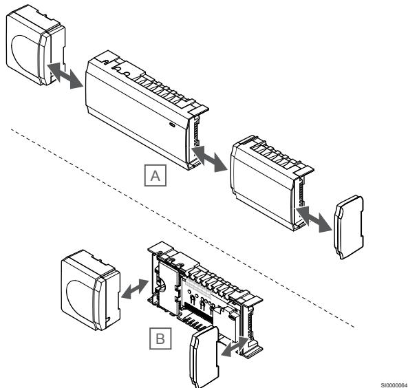
Komponente lahko enostavno namestite in jih odstranite, brez da bi odstranili pokrove (A – priporočeno na ploski površini ali DIN-letvi), ali jih vstavite na ustrezna mesta, potem ko ste odstranili pokrove (B).
