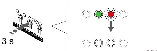
Pritisnite in držite gumb **V redu** na priključnem modulu, dokler se LED-diode ne izklopijo, da zaključite registracijo in se vrnete v obratovalni način.
