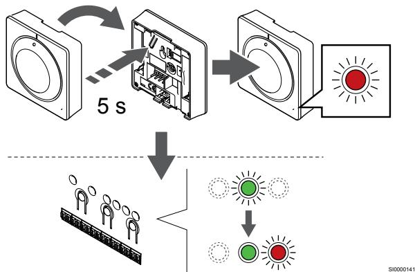
Nežno pritisnite in pridržite gumb za registracijo na termostatu ter ga izpustite, ko LED dioda na sprednji strani termostata začne utripati.
