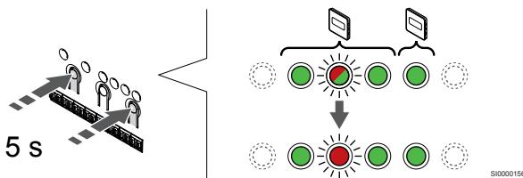
Pritisnite gumb **< in ura** ter ju držite približno pet (5) sekund, dokler LED-dioda izbranega kanala ne začne utripati v rdeči barvi.
