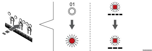
Pritisnite gumb **V redu** za vstop v način za registracijo sistemske naprave (LED-dioda napajanja). LED dioda napajanja začne utripati v skladu z vzorcem: dolg utrip, kratka pavza, dolg utrip. LED dioda na kanalu 1 začne utripati v rdeči barvi.
