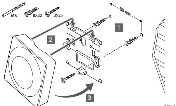
Termostat pritrdite na steno z uporabo stenskega nosilca, vijkev in zidnih vložkov.
