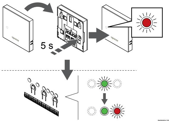
Nežno pritisnite in pridržite gumb za registracijo na termostatu ter ga izpustite, ko LED dioda na sprednji strani termostata začne utripati.
