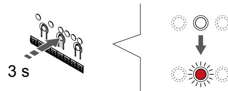
Pritisnite in držite gumb **V redu** na priključnem modulu, dokler LED-dioda na kanalu 1 (ali na prvem neregistriranem kanalu) ne začne utripati v rdeči barvi.
