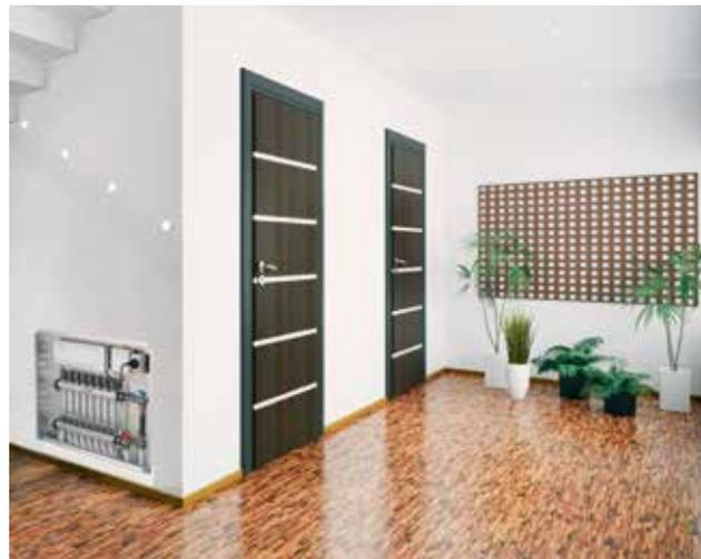
**Vario Heat Protect ist ein Verlegesystem zur Vermeidung unkontrolliert überheizter Räume, speziell Flure, Dielen oder Hauswirtschaftsräume und sorgt für die Reduzierung der Oberflächentemperaturen in Räumen, in denen Heizkreisverteiler montiert sind.**
