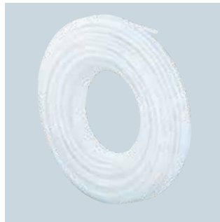
Il tubo Uponor Comfort Pipe PLUS - PE-Xa con barriera di diffusione dell'ossigeno realizzata in EVOH e uno strato protettivo esterno aggiuntivo. Di colore bianco con due strisce blu. È conforme alla norma DIN EN: ISO 15875 "Tubazioni in plastica per impianti di acqua calda e di acqua fredda, con polietilene reticolato", a tenuta di ossigeno nel rispetto della norma DIN 4726.
