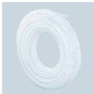
Uponor Minitec Comfort Pipe da 9,9 x 1,1 mm con barriera antiodiffusione dell'ossigeno realizzata in EVOH. Colore naturale con singola striscia di colore blu. È conforme alla norma DIN EN: ISO 15875 "Tubazioni in plastica per impianti di acqua calda e di acqua fredda, realizzate in polietilene reticolato", barriera ossigeno secondo la norma DIN 4726
