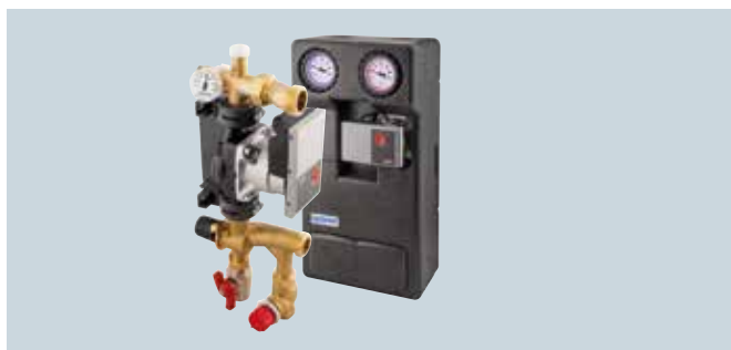
Gruppi pompa Uponor Fluvia - Stazioni compatte per la regolazione della temperatura di mandata per qualsiasi applicazione che fornisce la temperatura necessaria dell'acqua ai rispettivi impianti di riscaldamento/raffrescamento radiante Uponor.
