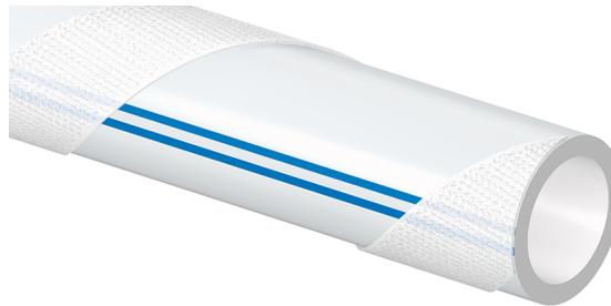
Uponor Comfort Pipe PLUS vrlo je fleksibilna PE-Xa cijev u 5 slojeva spiralno omotana s čičak-trakom dimenzija 14 x 2,0 mm i 16 x 2,0 mm.
