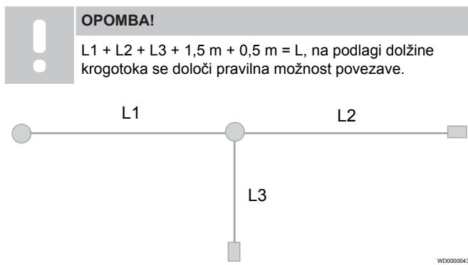
Dolžine cevi se seštejejo. Dodajte 0,5 m za priključek in zaključek ter 1,5 m za vsako vejo. Prav tako dodajte dovolj kabla, da ga boste lahko ovili okoli dodatnih virov toplotne izgube (ventili, dovodi itd.). V obsežnih omrežjih je treba vode združiti v ustrezne povezovalne krogotoke, da kabel zagotavlja zahtevano izhodno moč na meter (W/m) (glejte tabele grelne zmogljivosti).
