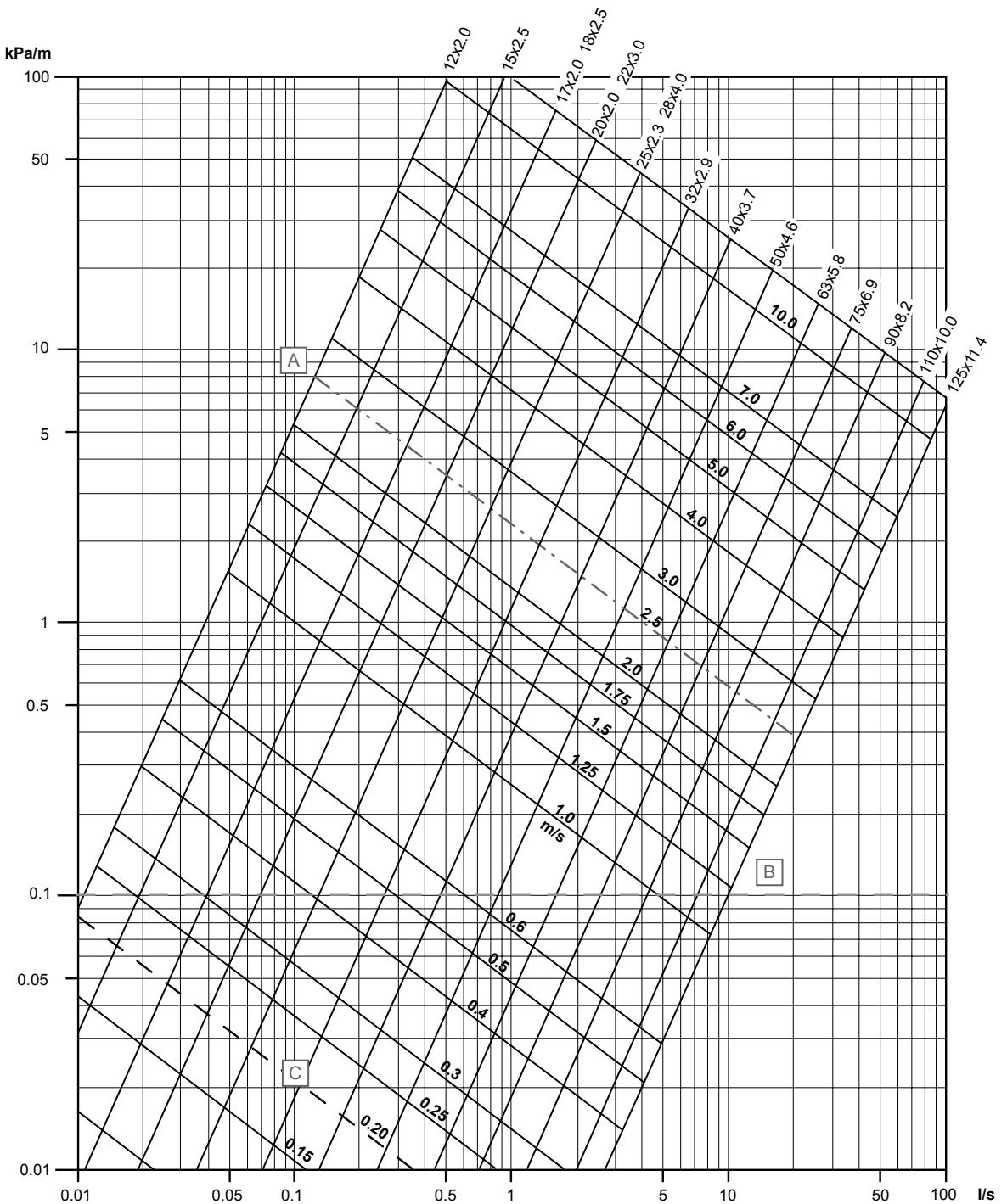
Nomogram je izračunan za temperaturo vode  $+70^\circ\text{C}$ .
