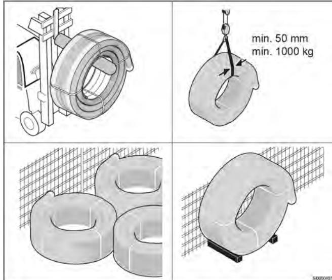
Kolutov ne vlecite po grobih površinah. Prepričajte se, da kolut ni pomečkan in da se na cevi ne pojavijo udrtine, ko so med skladisčenjem upognjene. Vse kolute skladisčite v vodoravnem položaju. Kolute cevi in jaške lahko skladisčite na prostem, druge komponente sistema pa v zaprtih prostorih.
