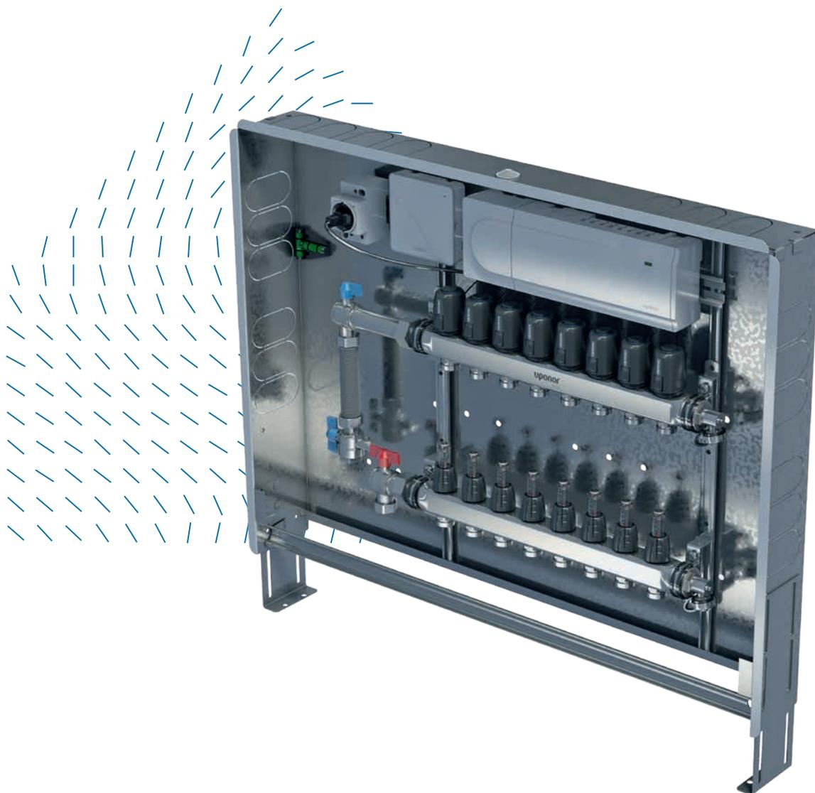
Uponor Comfort Port Verteilerstationen sparen wertvolle Montage- und Rüstzeit: durch die werkseitige Vorfertigung von Verteilerbalken und Anschlusssets im Verteilerschrank bis zur kompletten Einrichtung und Verdrahtung der Regelungstechnik auf der Regelklemmleiste und der Stellantriebe.
