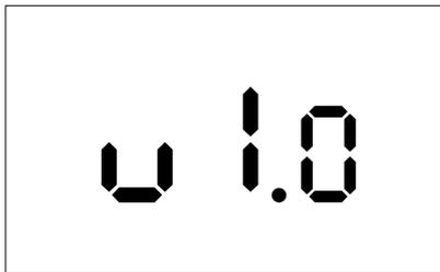
Die Softwareversion wird nach dem Einschalten oder Rücksetzen auf Werkseinstellung (gefolgt von einem Neustart) **drei Sekunden** lang angezeigt. Danach wird zum Hauptbildschirm geschaltet. Die LEDs leuchten 20 Sekunden lang auf, und wenn keine Aktivität erfolgt (keine Taste gedrückt wird), werden sie automatisch ausgeschaltet.
