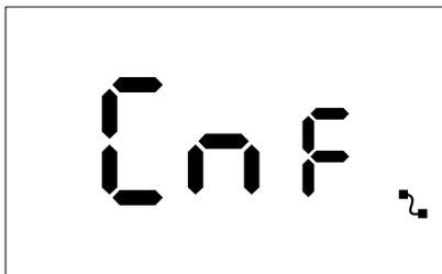
Wechseln Sie nachdem das Smatrix-Regelmodul auf Registriermodus eingestellt und die gewünschten Kanäle ausgewählt wurden zum Thermostat, und drücken Sie die Tasten + und - fünf Sekunden lang, um den Registriervorgang zu starten.
