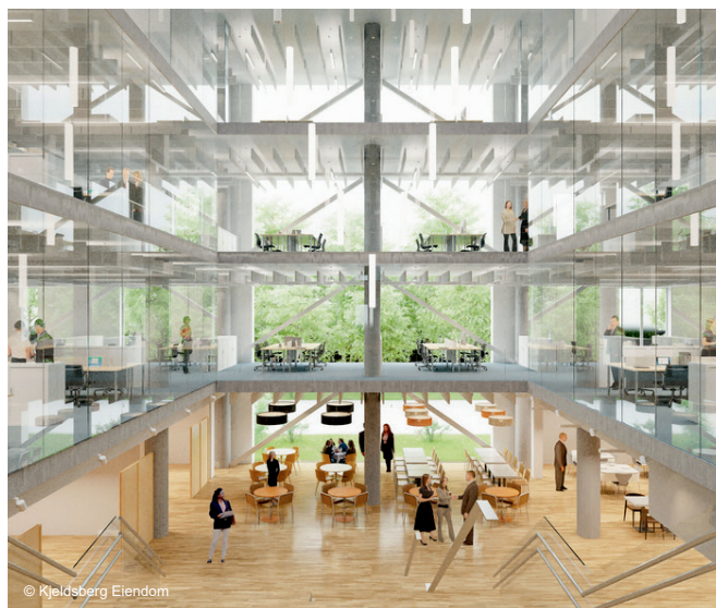
Concept de système avec activation de la masse béton et éléments de plafond verticaux pour l'absorption acoustique.
