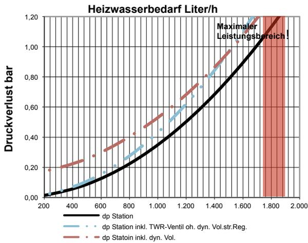
Passstück für WMZ 130x1" in Station vorh. Einbau eines WMZ: Qn 1,5 bzw. 2,5 je nach Hz-Volumenstrom. dP des WMZ ist in der Kurve nicht berücksichtigt. Fällt der Volumenstrom unter dem eingestellten und geplanten Wert fällt auch der dp der Station.!
