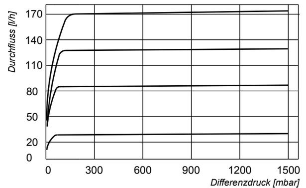
Durch die Handradeinstellung wird der maximal erforderliche Durchfluss (Volllastbetrieb) des Ventils eingestellt. Er kann nicht überschritten werden. Ein auf das Ventil aufgeschraubter Thermostat oder Stellantrieb kann im Teillastbetrieb den Durchfluss bis hin zu diesem max. Durchfluss regeln.
