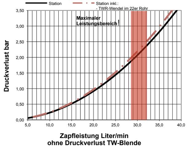
Passtück für WMZ 130x1" in Station vorh. Einbau eines WMZ: Qn 1,5 bzw. 2,5 je nach Hz-Volumenstrom. dP des WMZ ist in der Kurve nicht berücksichtigt. Fällt der Volumenstrom unter dem eingestellten und geplanten Wert fällt auch der dp der Station.!
