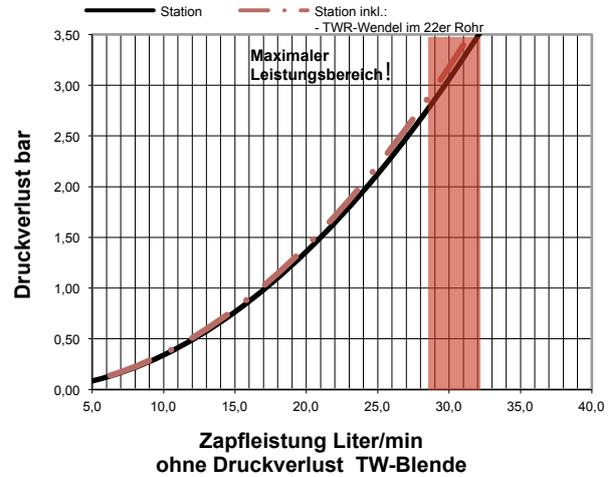
Beim Einsatz von Drosselscheiben 10-19 l/min muss ein Druckverlust von ca. 0,3-0,6 bar berücksichtigt werden.
