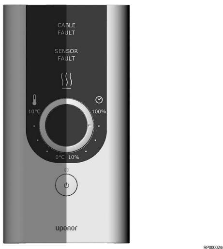
Mjerač vremena služi za regulaciju napajanja kabela. Omogууе jednostavno smanjenje potrošnje energije i sprječavanje štetnog zagrijavanja vode u cjevovodu. Područje regulacije mjeračа vremena odgovara ciklusu uključivanja od 30 minuta.
