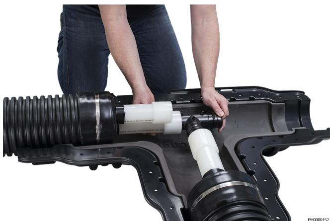
Fiting Uponor Q&E temelji se na metodi kod koje se cijev Uponor PE-Xa postupno širi prstenom Q&E (PEX) postavljenim s vanjske strane, a koji joj zatim omogućuje ponovno stezanje na odgovarajući nastavak. Ta se tehnika može upotrebjavati zbog činjenice da se materijal Uponor PEX može stisnuti natrag na svoju gotovo izvornu veličinu, čak i nakon vrlo velikog proširivanja.
