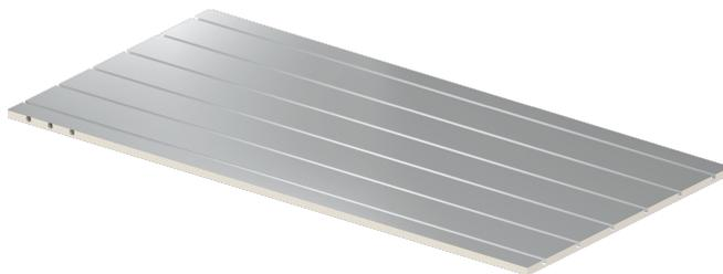
Uponor Siccus Mini panel je XPS panel od 400 kpa dimenzija 1200 x 600 x 15 mm i može se ugraditi na postojeće podove. Predgotovljeni panel ugrađuje se s utorima za cijevi s fiksnim razmakom cijevi od 100 mm.
