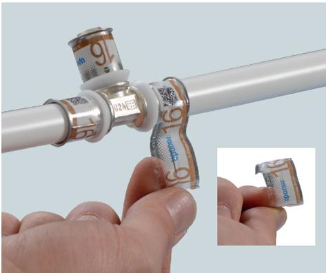
Nach dem Verpressen ist eine deutliche Verformung der Edelstahl-Presshülse sichtbar. Außerdem lässt sich die Folie nach erfolgreicher Verpressung einfach ablösen (Sichtkontrolle).
