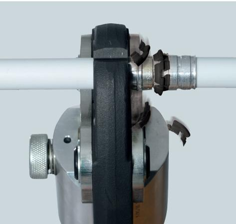
Beim Verpressvorgang löst sich der Anschlagring in Einzelteilen von der Presshülse ab.
