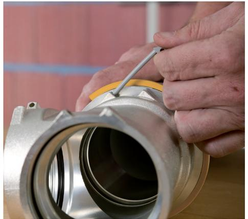
Abschließend das Verriegelungselement in die Öffnung des Grundkörpers einschieben und einrasten lassen.
