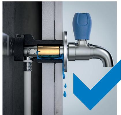
Die Schall- und Leckageschutzfunktion verhindert das Austreten von Wasser aus einer versehentlich undichten Gewindeeindichtung von Armaturenanschlüssen hinter der Wand: Eventuelles Leckagewasser wird mit der innovativen Drainagefunktion gezielt aufgefangen und an die Vorderseite der Wand abgeleitet, wo die Undichtigkeit direkt auffällt.
