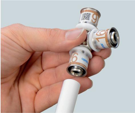
Uponor Verbundrohr in den Fitting einstecken. Das Rohrende muss zuvor nicht kalibriert und entgratet werden.
