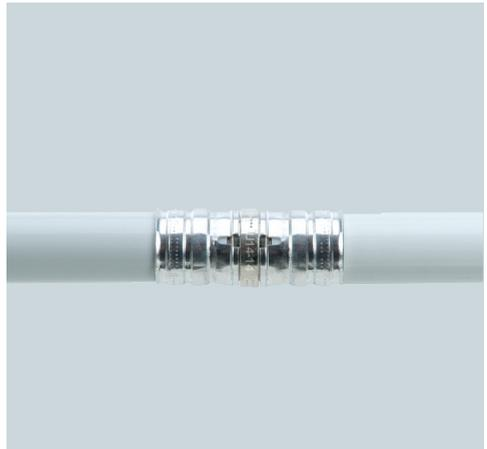
Die abgelösten Anschlagringe kennzeichnen eine erfolgreiche Verpressung, zuverlässig erkennbar selbst aus einigen Metern Entfernung.
