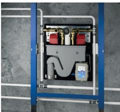
Uponor Motion ist eine montagefertige Spülstation zur automatisierten hygienischen Spülung von Kalt- und Warmwasserleitungen in ring- und Reiheninstallation gemäß VDI/DVGW-Anforderungen. Werkseitig vorgefertigt inkl. Dämmschale mit Gehäuseschutz.
