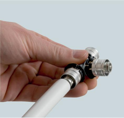
Das Verbundrohr kann ohne Entgraten oder Kalibrieren in den S-Press Fitting eingeschoben werden. Dabei am Sichtfenster des Fittings prüfen, ob das Rohr ganz bis zum Anschlag anliegt.
