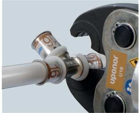
Die Pressbacke mit der gleichen Farbcodierung wie der Fitting wird an die Pressbackenführung der Edelstahl-Presshülse angelegt.
