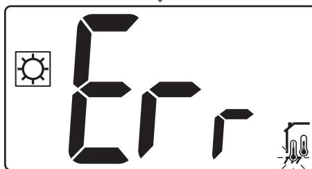
Если **неисправен внешний датчик (датчик пола)**, термостат продолжает измерять температуру с помощью внутреннего датчика.
