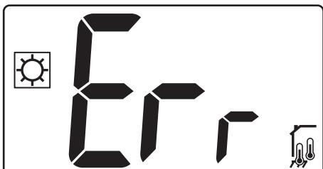
Если **внутренний датчик неисправен**, отображается «Err» и значки внутреннего датчика и датчика пола .
