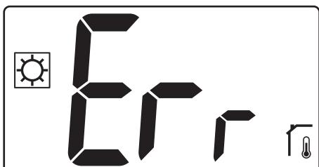
В режиме «rt» отображается «Err» и значок внутреннего датчика.
