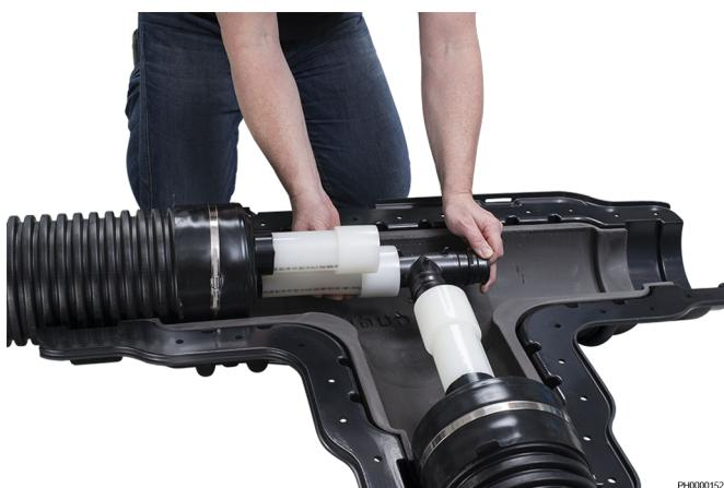
Montáž tvarovek Uponor Q&E je založena na metodě, při které se potrubí Uponor PE-Xa s převlečným kroužkem postupně rozšiřuje. Q&E (PEX) Poté se vsadí tvarovka a potrubí se smrští zpět. Tuto techniku je možné použít, protože materiál Uponor PEX se může smrštit zpět na téměř původní velikost, a to i po velmi velké míře rotazení.
