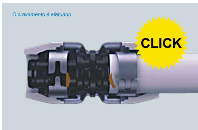
*O bloqueio de segurança solto pode ser visto pela janela de observação a 360°. Tem três funções: mantém o anel de cravamento sob tensão até este ficar cravado, contém o código de cor da dimensão e indica que o processo de cravamento foi concluído.*
