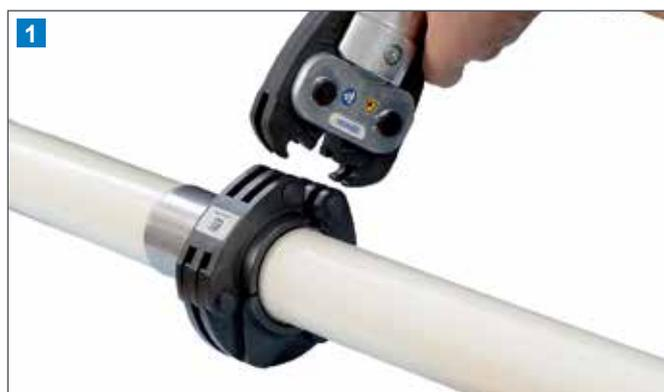
1 Enfiar a ponta escareada do tubo multicamada na união até não ser mais possível empurrar. Em seguida, colocar a cabeça de cravamento adequada (mesma dimensão e mesmo código de cor da união) em torno do casquilho de cravamento até ao batente de cor.
