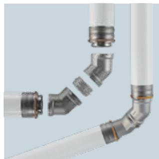
*Ângulos flexíveis – especialmente nos edifícios antigos em que as paredes e os tetos não são, muitas vezes, perpendiculares entre si. Utilizando espaçadores (5 mm) em conjugação com dois joelhos de 45°, pode obter-se qualquer ângulo desejado simplesmente rodando os componentes.*
