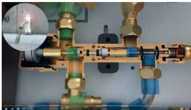
O sinal de arranque é dado pela abertura de consumo de água quente. A pressão da água fria empurra o regulador PM para a esquerda no diafragma cilíndrico, iniciando a distribuição de água quente. O caminho até ao permutador de calor para o sistema de aquecimento é aberto em resposta às necessidades de água quente. O aquecimento doméstico é desativado enquanto a torneira de água quente está a ser utilizada. A proporcionalidade no lado do aquecimento é assegurada por meio de uma tampa.
