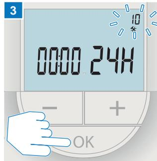
Nach Drücken der **OK Taste** blinkt die Stundenanzeige der Uhrzeit, die Sie mit den **-/+ Tasten** einstellen können.
