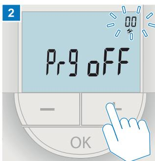
Das aktuell angezeigte Einstellungs-Menü rechts oben im Display blinkt. Wählen Sie mit den **[-] [+] Tasten** das gewünschte Einstellungs-Menü aus.
