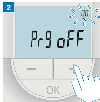
Das Einstellungs-Menü **00** in der oberen rechten Ecke blinkt. Drücken Sie die **[+] Taste**, bis das Menü **03** angezeigt wird.
