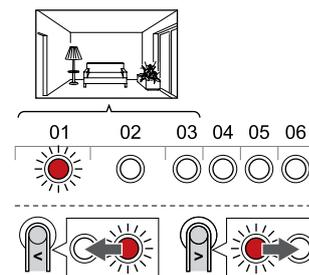
Bruk knapper < eller > for å flytte pekeren (LED blinker rødt) til den første tomme kanalen som trengs for rommet (ingen LED). Dioden blinker rødt.
