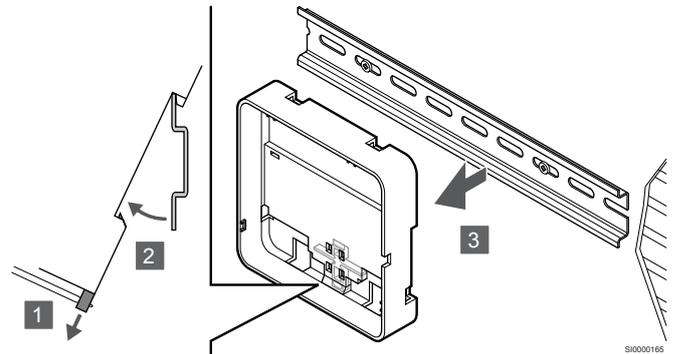
1. Bruk en skrutrekker (eller lignende) og utvide den fjærende plastfangeren fra kommunikasjonsmodulen bakmonteringen.
