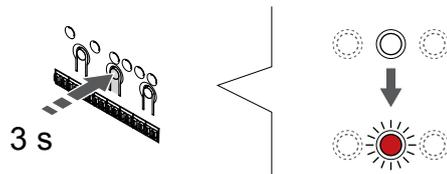
Trykk og hold **OK** knappen på sentralenheten til LED for kanal 1 (eller den første uregistrerte kanalen) blinker rødt.
