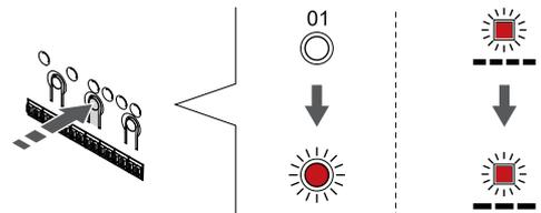
Trykk på **OK** knappen for å gå inn i systeminnstillingsmodusen (strømlampe). LED-pæren for strøm begynner å blinke, først ett langt blink, en kort pause og så et langt blink. Kanal 1 blinker rødt.
