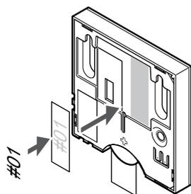
Merk termostaten, hvor egnet, med kanalnummerene de skal kontrollere, for eksempel # 02, # 03. For et system med flere sentralenheter, legg til ID for hver sentralenhet, for eksempel 1.02, 1.03, 2.02, 2.03.
