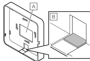
Kjør kabler til kommunikasjonsmodulen ved hjelp av en av to kabeloppføringer.
