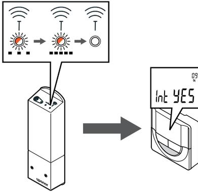
Indikatoren for tilkobling blinker i termostatdisplayet for å vise at registreringsprosessen starter.
