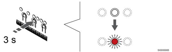
Trykk og hold **OK** knappen på sentralenheten til LED for kanal 1 (eller den første uregistrerte kanalen) blinker rødt.
