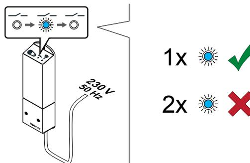
Slå på relémodulen og telle antall blinker av LED 2 (blå) for å sikre at den er i normal kjøremodus.
