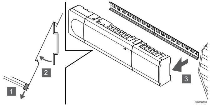
1. Bruk en skrutrekker (eller lignende) og strekk den fjærende plastfangeren fra sentralenheten.
