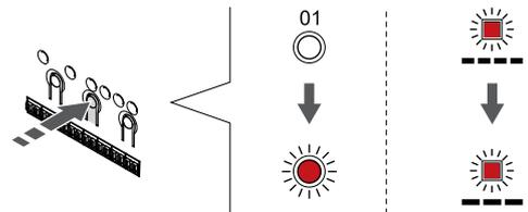
Trykk på **OK** knappen for å gå inn i systeminnstillingsmodusen (strømlampe). LED-pæren for strøm begynner å blinke, først ett langt blink, en kort pause og så et langt blink. Kanal 1 blinker rødt.
