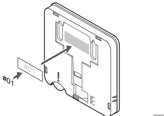
Merk termostaten, hvor egnet, med kanalnummerene de skal kontrollere, for eksempel # 02, # 03. For et system med flere sentralenheter, legg til ID for hver sentralenhet, for eksempel 1.02, 1.03, 2.02, 2.03.
