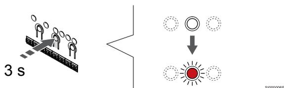
Trykk og hold **OK** knappen på sentralenheten til LED for kanal 1 (eller den første uregistrerte kanalen) blinker rødt.
