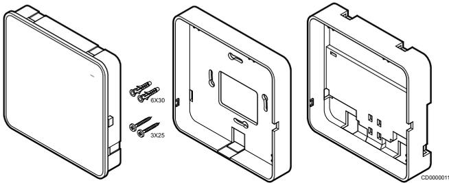
Kommunikasjonsmodulen leveres med et sett med skruer, veggkontakter og et valgfritt baksidedefeste for DIN-skinne, noe som gir flere alternativer for feste av kommunikasjonsmodulen til vegg.
