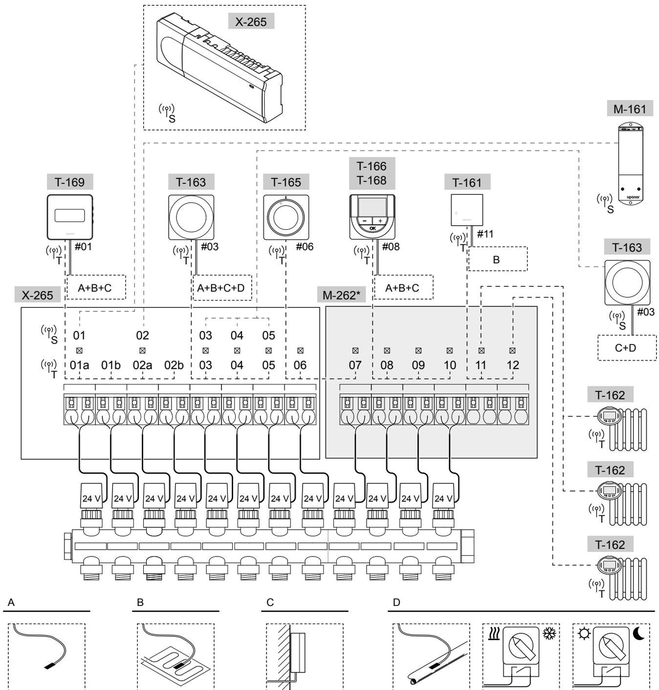
\*) Dette eksemplet inneholder tilleggsutstyr som legger til seks aktuatorutganger (slavemodul M-262) på Uponor Smatrix Wave Pulse sentralenhet
