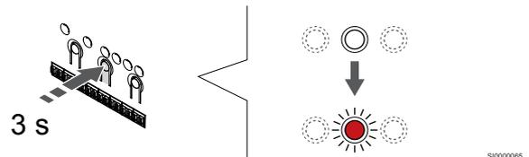
Trykk og hold **OK** knappen på sentralenheten til lysdioden for den første uregistrerte kanalen blinker rødt. Hvis alle kanalene er registrert i termostater, blinker LED-lyset rødt og grønt.
