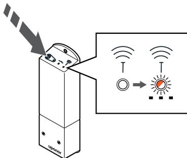
Trykk og hold inne registreringsknappen på relémodulen til LED-lysene på modulen begynner å blinke sakte.
