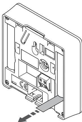
Fjern plasttransportbåndene fra batteriene for å starte termostaten.
