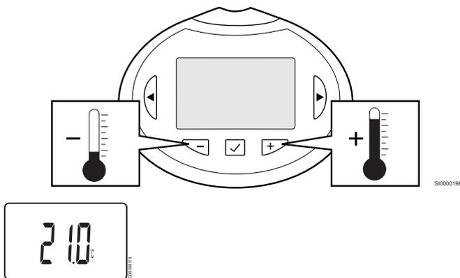
Slik justerer du temperatursettpunktet for gjeldende kontrollmodus på termostathodet:
