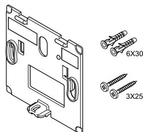
Termostaten leveres i et sett med skruer, veggkontakter og en veggbrakett, og presenterer flere alternativer for å feste termostaten til veggen.
