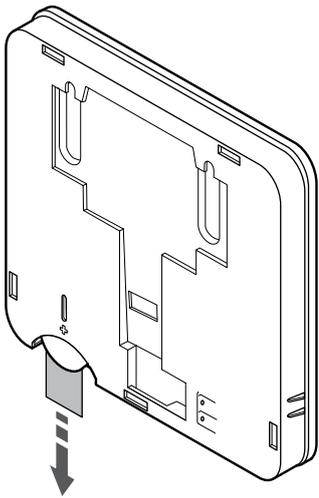
Fjern plasttransportbåndet fra batteriet for å starte termostaten.
