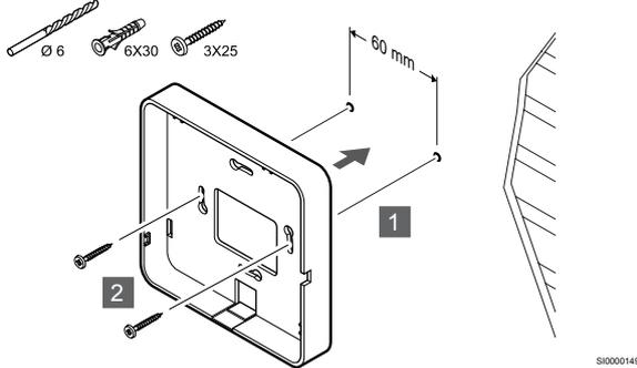
Fest kommunikasjonsmodulen bakmontert til veggen med skruene og veggkontaktene.
