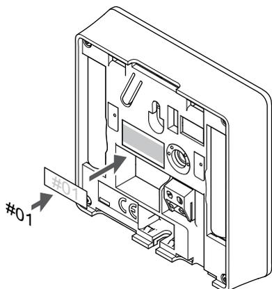
Merk termostaten, hvor egnet, med kanalnummerene de skal kontrollere, for eksempel # 02, # 03. For et system med flere sentralenheter, legg til ID for hver sentralenhet, for eksempel 1.02, 1.03, 2.02, 2.03.
