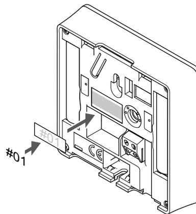
Merk termostaten, hvor egnet, med kanalnummerene de skal kontrollere, for eksempel # 02, # 03. For et system med flere sentralenheter, legg til ID for hver sentralenhet, for eksempel 1.02, 1.03, 2.02, 2.03.
