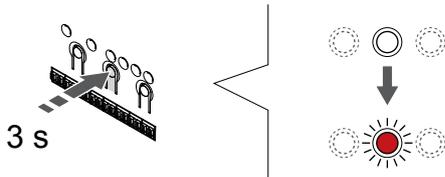
Trykk og hold **OK** knappen på sentralenheten til LED for kanal 1 (eller den første uregistrerte kanal) blinker rødt.
