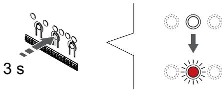
Trykk og hold **OK** knappen på sentralenheten til LED for kanal 1 (eller den første uregistrerte kanalen) blinker rødt.
