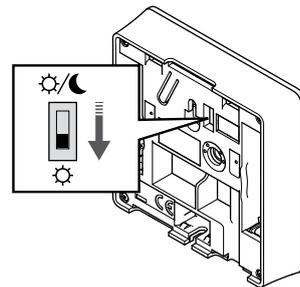
Valgfritt: For å aktivere tamperalarm for termostaten, still inn deaktivere tidsbryteren til komfortmodus (☀) før du registrerer termostaten.
