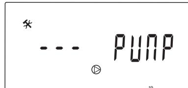
Postavite koliko će dugo cirkulacijska pumpa biti isključena nakon zatvaranja ventila za miješanje.
