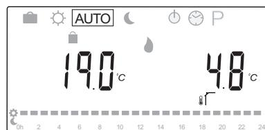
Nakon tih 7 sekundi umjesto izračunate temperature prikazat će se trenutačna polazna temperatura. Tipkom **OK** ove dvije vrijednosti mogu se prebacivati u bilo kojem trenutku kada je sustav u **automatskom načinu**.
