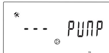
Establezca el intervalo durante el que la bomba de circulación estará apagada una vez que se cierre la válvula de mezclado.
