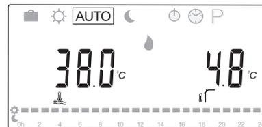
La hora actual del día parpadeará constantemente en la parte inferior de la pantalla, mostrando el modo que esté activado en ese momento (Confort o ECO). Esto requiere que la fecha y la hora estén configuradas, y que se haya seleccionado un programa.
