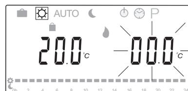
Al salir del modo de edición inicial, bien esperando durante unos 7 segundos o pulsando el botón **OK**, la unidad base mostrará las temperaturas de suministro y exterior actuales. Utilice el botón **OK** para cambiar entre los modos de edición y de visualización.
