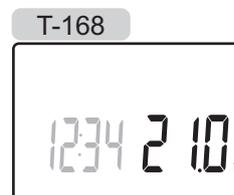
2. Pulse el botón - o + (T-169 = ▼ o ▲) repetidamente para seleccionar la temperatura de consigna. Cambiará con incrementos de 0,5.
