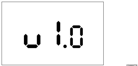
Verzija softvera se prikazuje **3 sekundi** posle uključivanja ili resetovanja na fabričke postavke (što prati ponovno pokretanje), nakon čega će se prikazati glavni ekran. LED lampice će biti uključene 20 sekundi, a ako nema aktivnosti (nijedno dugme se ne pritisne), automatski će se isključiti.
