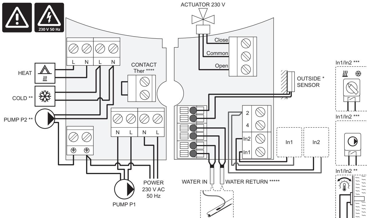
\*) La sonda de temperatura exterior se puede conectar bien a la unidad base o bien a un termostato (se requiere la antena A-155).
