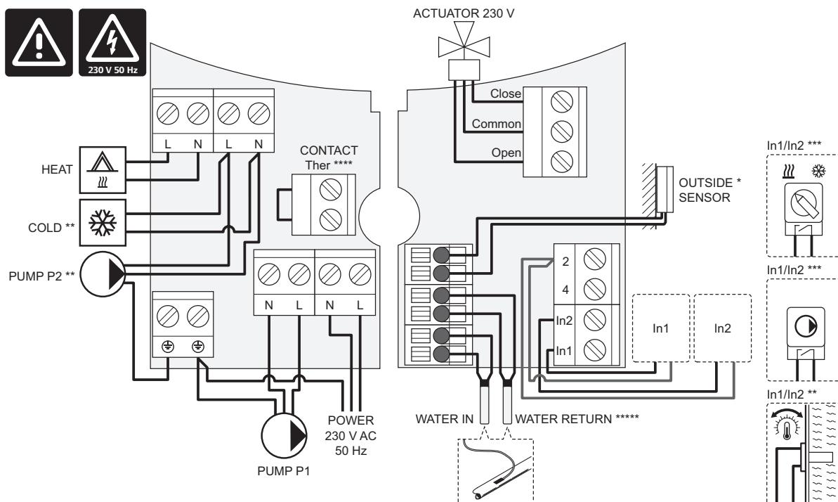
\*) Utetemperaturføleren kan kobles enten til kontrolleren eller til en termostat (krever antennen A-155).
