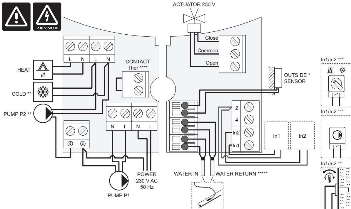
\*) Der Außenfühler kann entweder an das Regelmodul oder einen Fühler angeschlossen werden (Antenne A-155 erforderlich).
