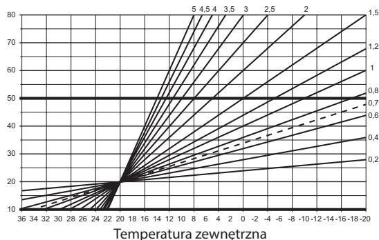
Wybór krzywej zależy od różnych czynników (np. jakości izolacji w budynku, położenie geograficzne, typ systemu ogrzewania/chłodzenia itd.).
