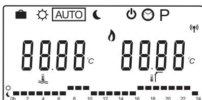
Utiliser les boutons < ou > pour modifier le mode de fonctionnement. Une case indique quel mode a été sélectionné.
