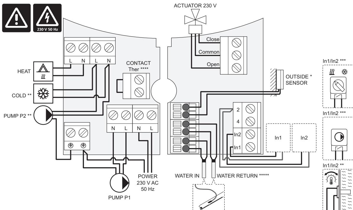
\*) Zewnętrzny czujnik temperatury można podłączyć do sterownika lub termostatu (wymagana antena A-155).
