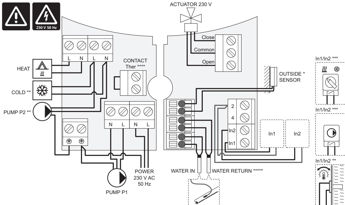
\*) Udendørstemperaturføleren kan enten sluttet til kontrollenheden eller til en termostat (kræver antennen A-155).
