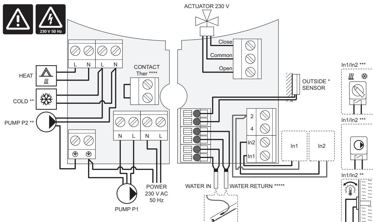
\*) La sonde de température extérieure peut être raccordée aussi bien à la centrale de régulation qu'à un thermostat (antenne A-155 requise).
