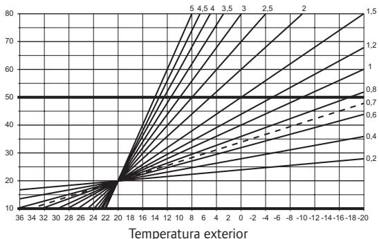
A escolha de curva depende da combinação de diferentes fatores, como o isolamento da casa, a localização geográfica, o tipo de sistema de aquecimento/refrigeração, etc.
