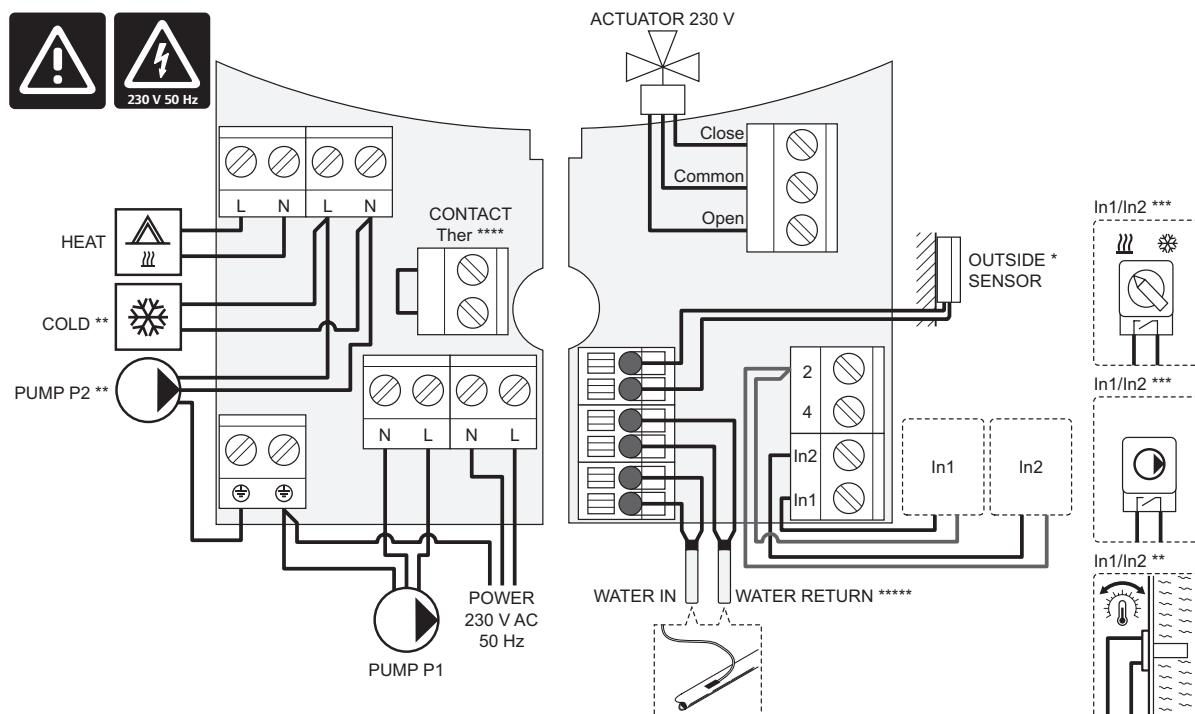
\*) A sonda de temperatura exterior pode ser ligada ao controlador ou ao termóstato (requer a antena A-155).
