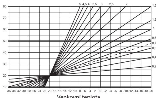
Volba křivky závisí na kombinaci různých faktorů, například způsobu izolování domu, zeměpisné umístění, typu systému topení/chlazení atd.
