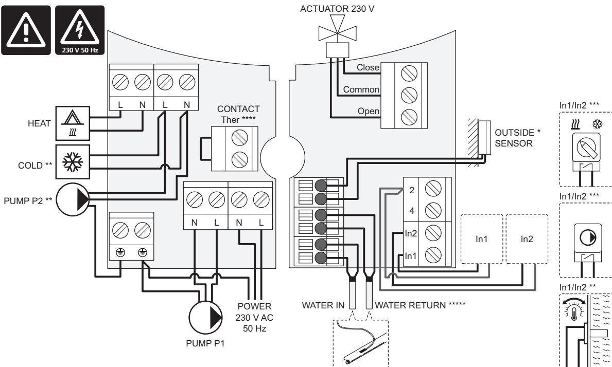
\*) Ulkolämpötila-anturi voidaan kytkää joko keskusyksikköön tai termostaattiin (tarvitaan antenni A-155).
