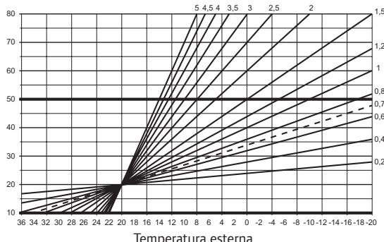
La scelta della curva dipende da una combinazione di fattori quali l'isolamento dell'abitazione, la posizione geografica, il tipo di impianto di riscaldamento/raffrescamento ecc.
