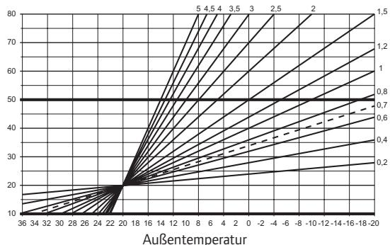
Die Wahl der Kurve hängt von einer Kombination verschiedener Faktoren wie Isolierung des Hauses, geografischer Standort, Art der Heiz-/Kühlungsanlage etc. ab.
