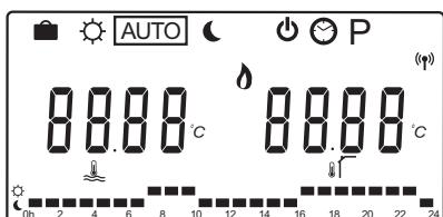
Utilizați butoanele < sau > pentru a schimba modul de funcționare. Modul selectat este indicat printr-o căsuță.
