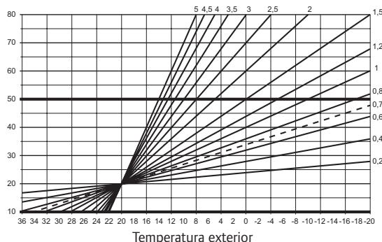
La elección de la curva depende de una combinación de diferentes factores, como el nivel de aislamiento de la casa, la ubicación geográfica, el tipo de sistema de calefacción/refrigeración, etc.
