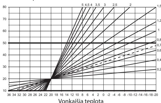
Výber krivky závisí od kombinácií rôznych faktorov, napríklad od kvality izolácie domu, od geografickej polohy, typu vykurovacieho/chladiaceho systému, atď.
