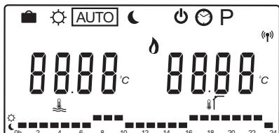
Brug knappen < eller > til at ændre driftstilstand. En boks viser, hvilken tilstand der er valgt.
