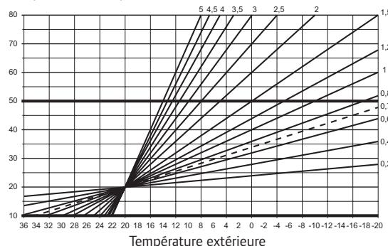
Le choix de la courbe dépend d'une combinaison de plusieurs facteurs tels que le niveau d'isolation de la maison, sa situation géographique, le type de système de chauffage/rafraîchissement, etc.
