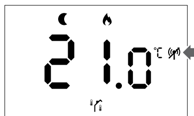
Ábra 1. Példa egy ECO üzemmódban, kérés nélkül, RO vezérlési módban működő fűtési rendszerről
