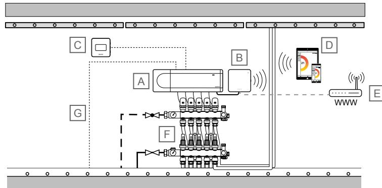
Master room styringen tilslutter fra cirkulationspumpe relæ (relæ 1) til en af ROOMSTAT-indgangen til styringen for fremløbstemperatur (opsætning som **C\_b**). Når relæet i rumstyringen lukkes, starter styringen til fremløbstemperatur cirkulationspumpen.
