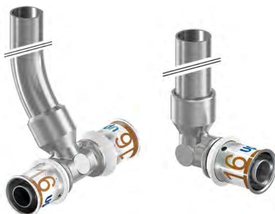
Raccords en laiton étamé avec connexion Uponor S-Press PLUS et tube cuivre nu ou revêtu 15 x 1 mm en longueurs 365 et 1115 mm. En option pour tubes multicouche Uponor 16 mm. Raccordement radiateur via l'adaptateur de compression Uponor Smart radi Cu.
