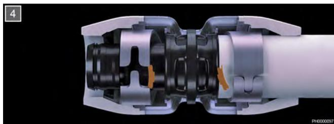
Un sertissage réussi est visible à travers la fenêtre d'inspection transparente. Si l'entretoise à code couleur a été poussée à travers l'extrémité du tube et hors de la bague de sertissage précontrainte, la bague de sertissage est fermée.
