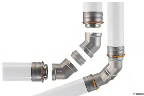
Angles flexibles – les murs et les plafonds ne sont souvent pas perpendiculaires les uns aux autres, en particulier dans les bâtiments anciens. En utilisant des adaptateurs de distance (5 mm) en conjonction avec deux angles de 45°, n'importe quel angle souhaité peut être obtenu en tournant simplement les composants.
