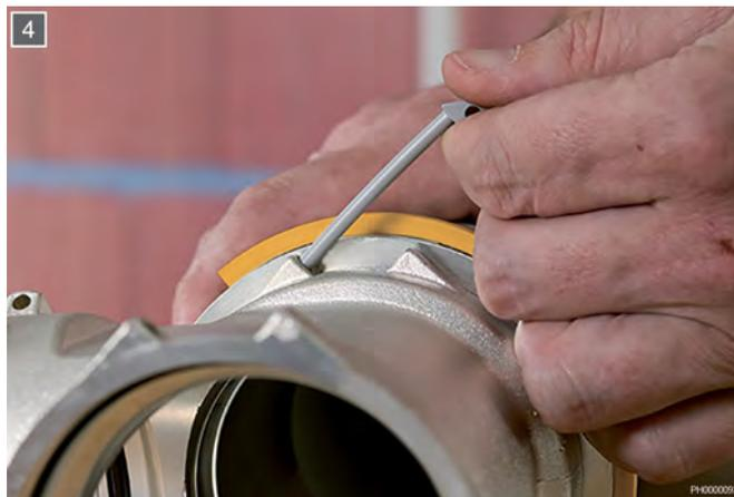
Enfin, faites glisser l'élément de verrouillage dans l'ouverture du corps de base et laissez-le s'enclencher.
