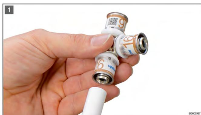
Insérez le tube Uponor dans le raccord. L'extrémité du tube ne doit pas être ébavurée ou calibrée au préalable.
