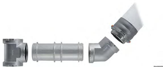
Des points fixes sont souvent nécessaires dans les systèmes de canalisation avec de longues sections d'alimentation. Les adaptateurs de distance (RS2/RS3) permettent de les créer rapidement et facilement. Les barres circonférentielles au milieu des adaptateurs d'écartement facilitent la fixation des pinces à point fixe.
