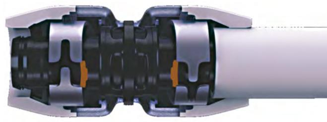
Lorsque le tube multicouche est inséré dans le raccord à serrer RTM, le verrou de sécurité est libéré de la bague de serrage. Un clic clair peut être entendu pour signaler la connexion réussie.
