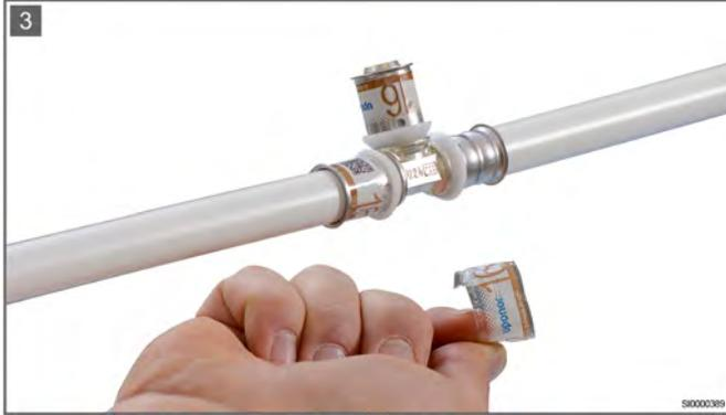
Après le sertissage, une déformation nette du manchon sertie en acier inoxydable est visible. De plus, le film peut être facilement retiré après un sertissage réussi (contrôle visuel).
