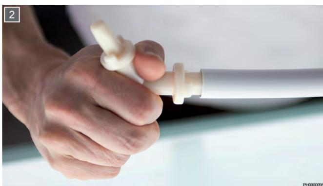
Avant l'assemblage du raccord, l'extrémité du tube doit être calibrée.
