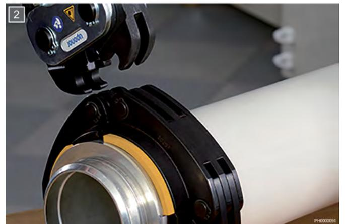
Une connexion permanente est établie à l'aide de la chaîne de sertissage et de la mâchoire de sertissage de base correspondante.
