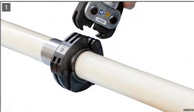
Insérez l'extrémité du tube ébavurée dans le raccord aussi loin que possible. Placer ensuite l'insert de sertissage appropriée (même dimension et même code couleur que le raccord) autour du manchon de sertissage jusqu'à la butée de couleur.
