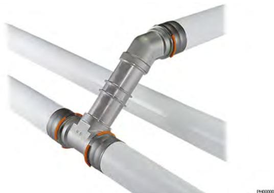
Modifications simples et rapides des niveaux de canalisation - en utilisant des adaptateurs de distance en combinaison avec des angles de 45°, les changements de niveau sont possibles avec des différences de hauteur minimales.
