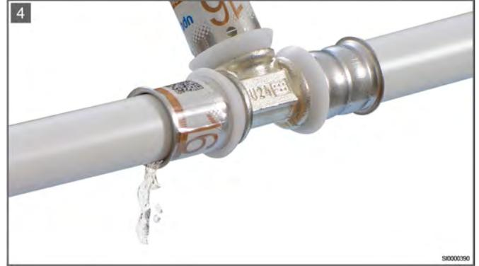
Les connexions non serties sont détectées de manière fiable comme non étanches lors du test d'étanchéité grâce à la fonction « non sertie, non étanche ». Un raccord non sertie se distingue également clairement du fait que la feuille indicatrice est toujours présente sur le manchon de sertissage en acier inoxydable.
