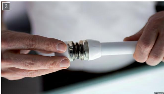
Le processus de sertissage est contrôlé en insérant le tube jusqu'à ce que le clic se fasse entendre.
