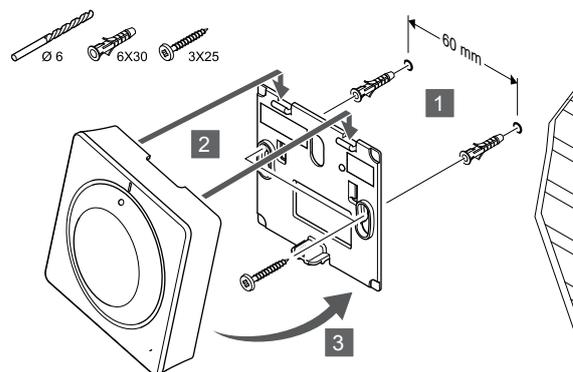
Fixe o termóstato à parede utilizando o suporte de parede, parafusos e buchas.
