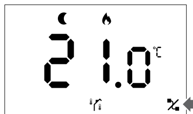
Figură 1. Exemplu dintr-un sistem de încălzire care funcționează în modul Eco fără cerere, în modul de control RO
