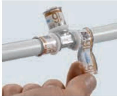
Después de prensar, retirar la lámina del accesorio UPONOR S-Press PLUS y se observará la marca de unión en el casquillo de acero inoxidable.
