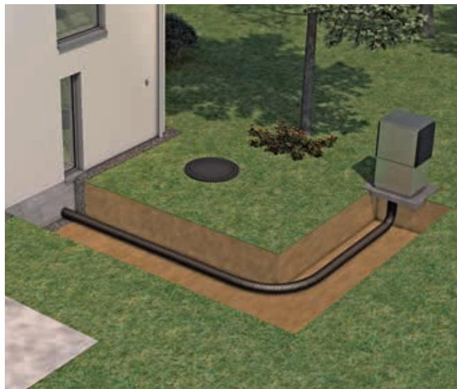
Ligação com Uponor Ecoflex Thermo Twin HP entre uma bomba de calor externa monobloco e um edifício residencial.
