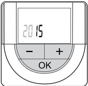
Mit den Tasten - oder + um stellen sie den gewünschten Werte ein und drücken Sie dann auf OK, um die Einstellung des Wertes zu betätigen und zum nächsten editierbaren Wert zu wechseln.
