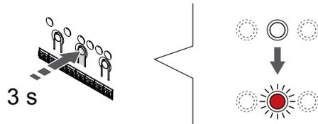
Halten Sie die Taste **OK** am Regelmodul, bis die LED für Kanal 1 (oder den ersten nicht registrierten Kanal) rot blinkt.
