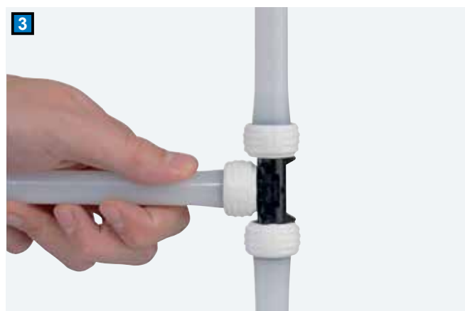
Dopo l'espansione inserire sul raccordo fino a battuta, premere per qualche secondo che il tubo e l'anello Q&E si restringano. Fatto!
