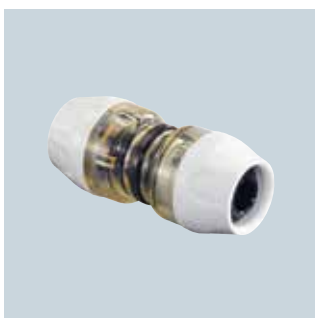
Raccordi Uponor RTM in PPSU – con funzione di pressione integrata, identificazione dello stato di pressione e codice colore.
