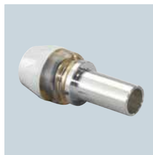
Raccordi Uponor RTM in PPSU – con funzione di pressione integrata, identificazione dello stato di pressione e codice colore.
