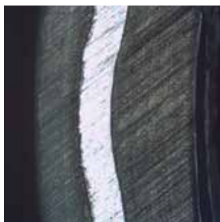
Alluminio senza saldatura (nuova tecnologia SACP)
